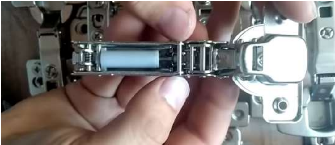
Рис. Завіса DTC з дотягувачем - газований ліфт
