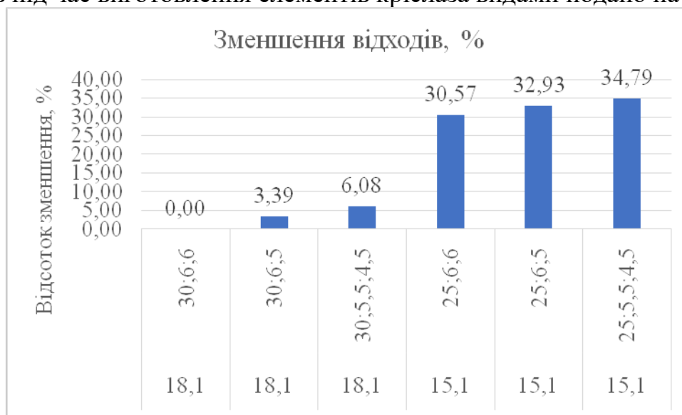
Рис. 4.12. Номограми зменшення (%) деревинних відходів за видами при різних величинах усушки та величини припусків під час виготовлення елементів крісла
