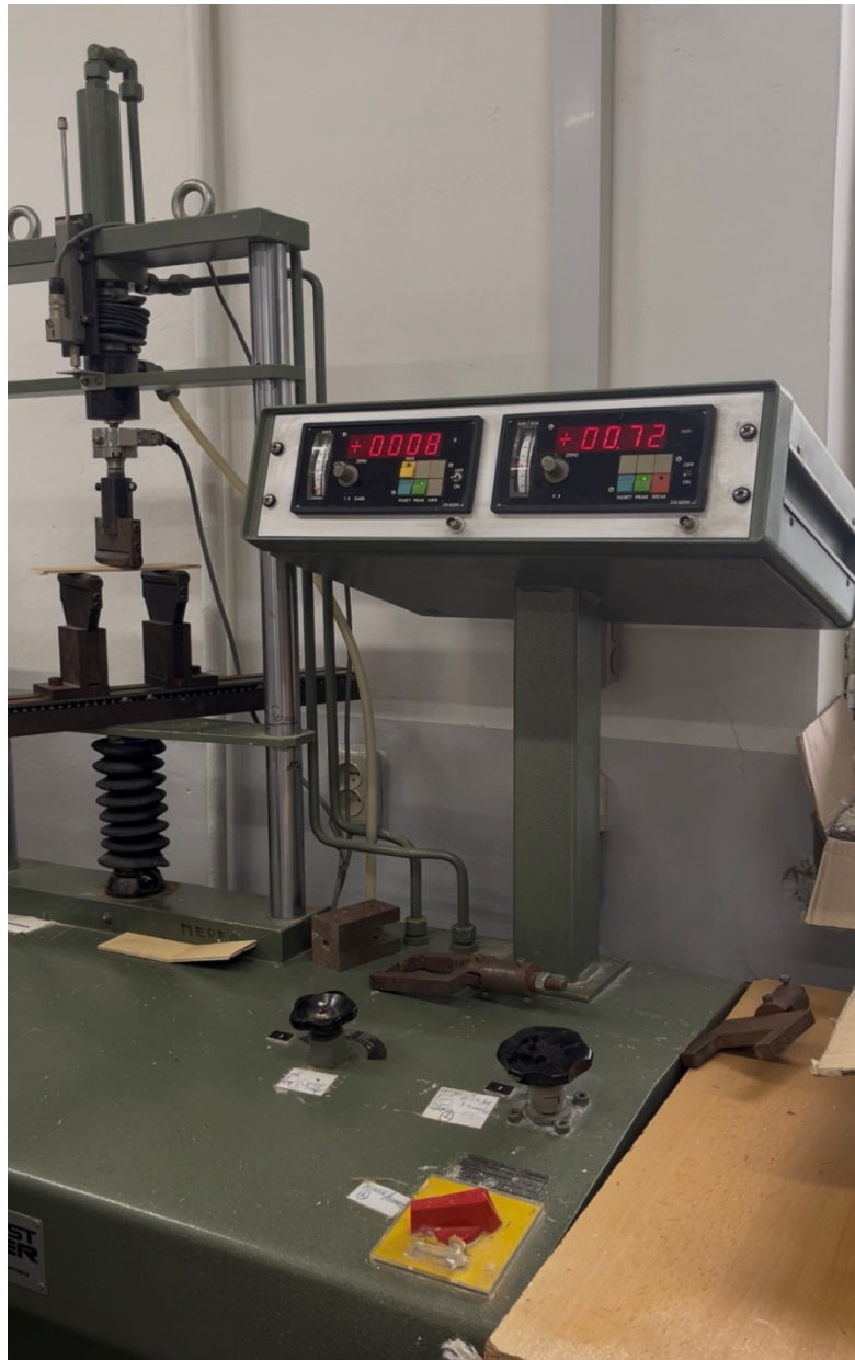
Рис. 2.7 – Момент випробування зразків на міцність і модуль пружності фанери під час статичного згинання.
