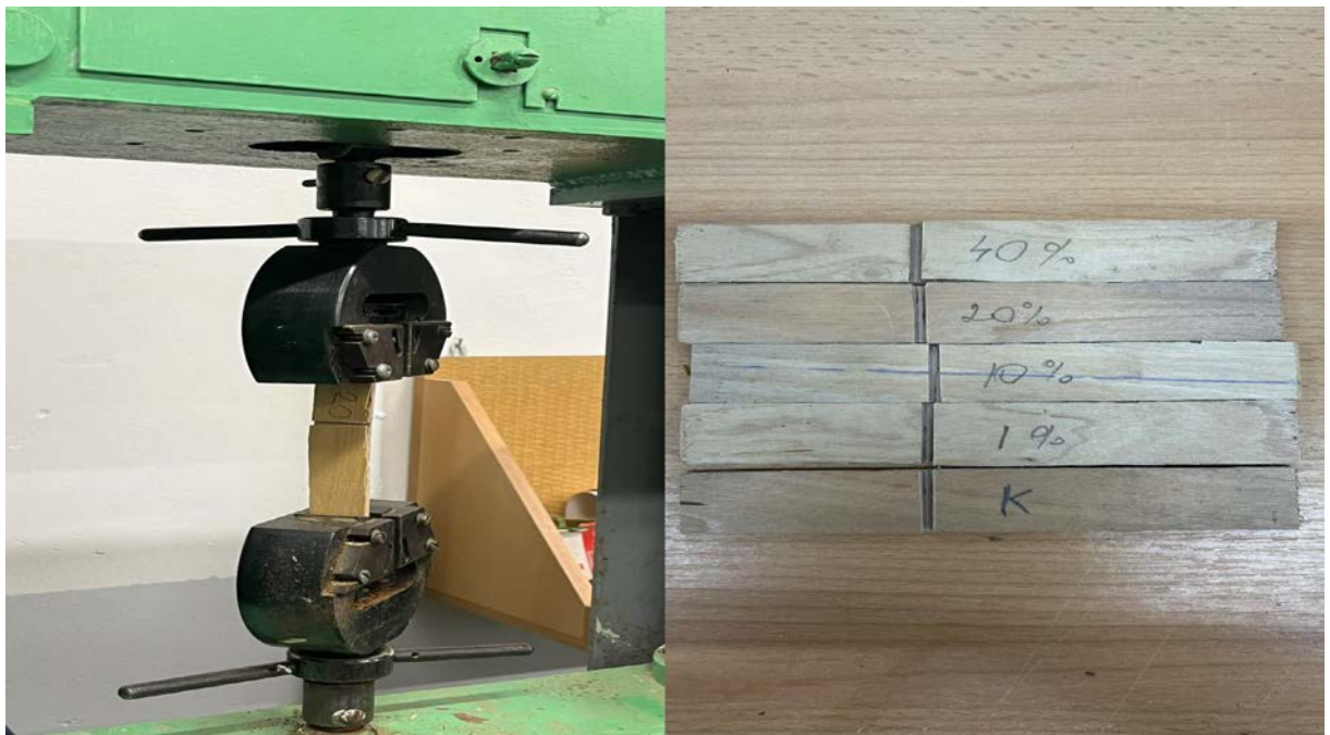
Рис. 2.5 – Робочий момент визначення міцності фанери на зріз: 1 – зразок фанери в момент випробування; 2 – зразки фанери.
