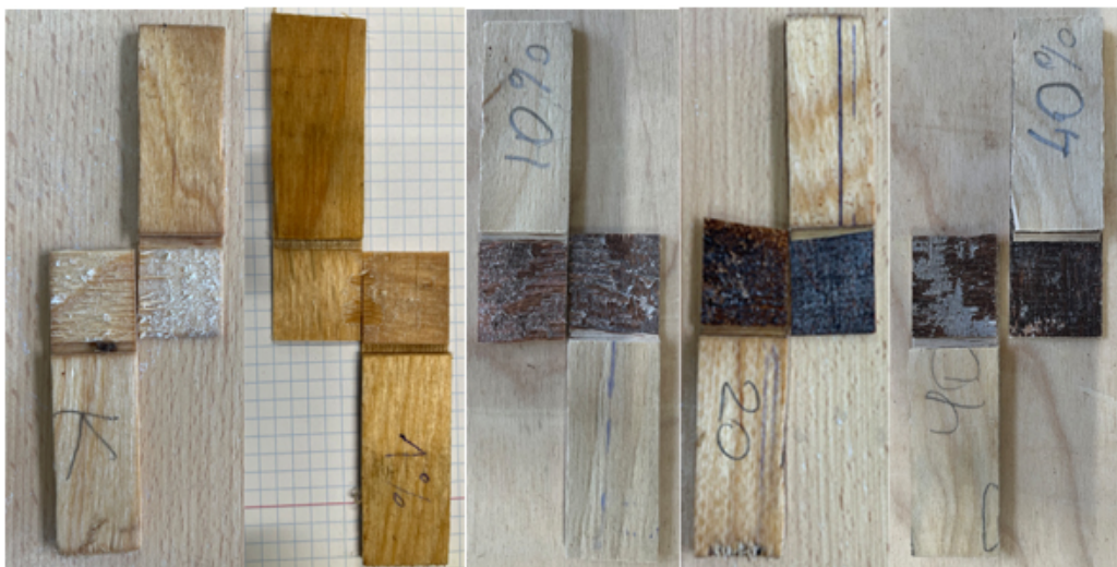
Рис. 3.5 – Характер руйнування на зріз зразків фанери з шпоном обробленого сірчаноокислим глиноземом різної концентрації.
