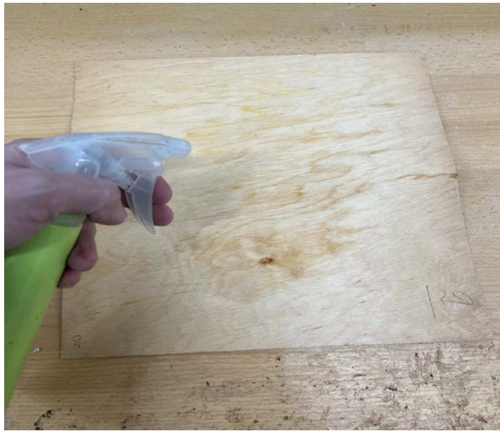
Рис. 2.1 – Нанесення сірчаноокислого глинозему на поверхню шпону
