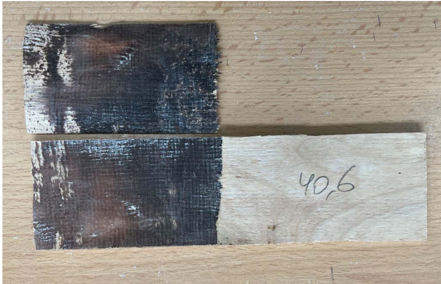
Рис. 3.2 – Зовнішній вигляд руйнування зразка після випробувань на визначення міцності під час статичного згинання та поверхні шпону обробленої 40% сірчанокислим глиноземом.
