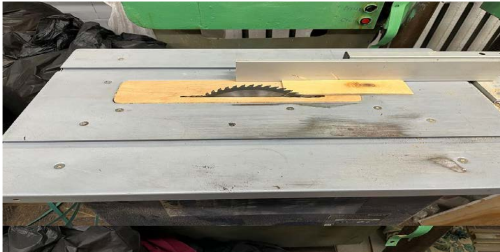
Рис. 2.3 – Робочий момент вирізання зрізків фанери для випробування на фізико-механічні властивості.
