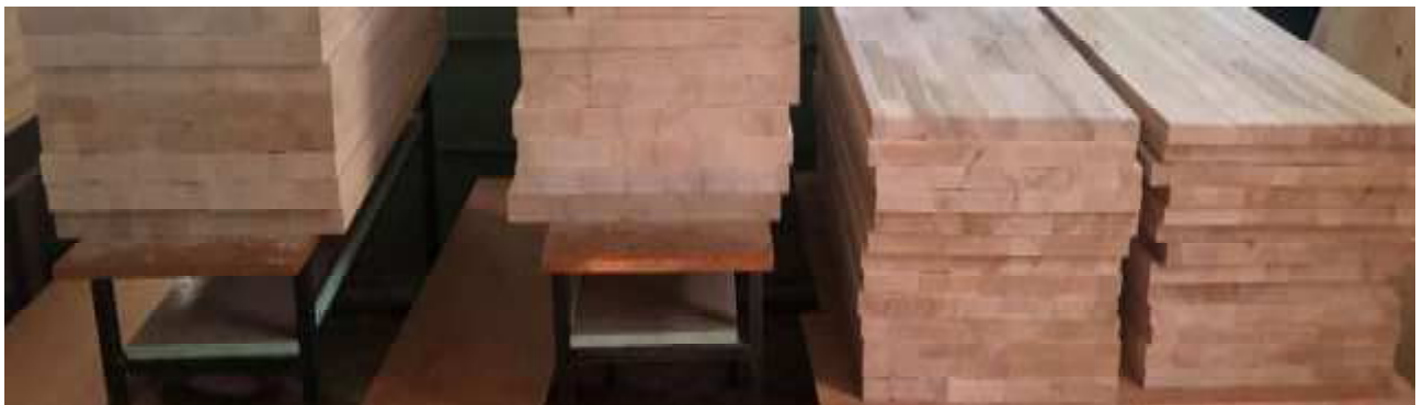
Рис. 3.7. Експериментальні партії меблевих щитів різних конструкцій із деревини твердолистяних порід, зокрема бука звичайного ( Fagus sylvatica L.) для випробувань на формостійкість
