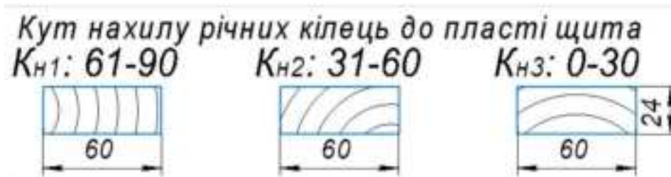
Рис. 2.2. Перерізи ламелей з величинами кутів між дотичною річного кільця в ламелі до загальної площини МЩ: 1-30° – тангентальний; 31-60° – напіврадіальний; 61-90° – радіальний
