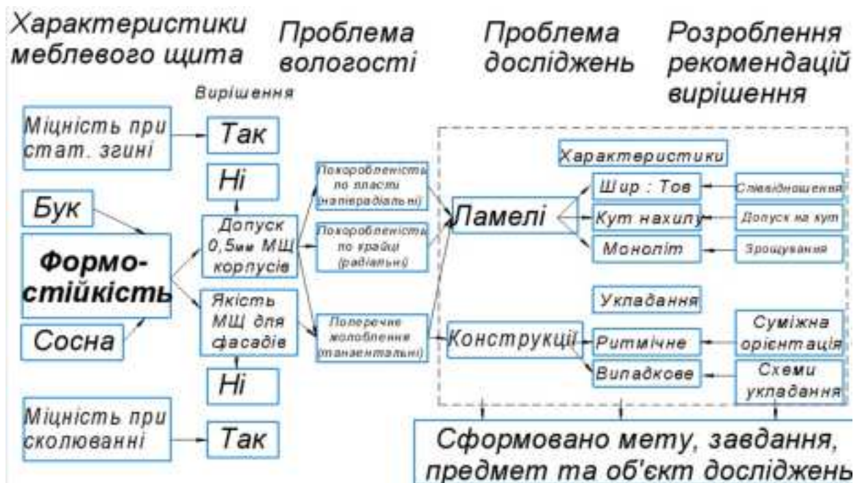
Рис. 1.14. Принципова схема вирішення проблеми досліджень закономірностей впливу розмірних характеристик бездефектних ділянок соснових та букових ламелей на формостійкість меблевих щитів
