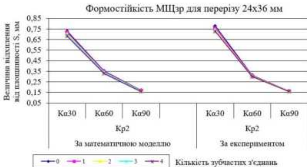
Рис. 4.24. Графічний лінійний порівняльний аналіз величин стріл прогину – відхилення від площинності за результатами експерименту та розрахунку за моделлю для рейок з різною кількість зубчастих з'єднань перерізом 24×36 мм K_{p2} (співвідношення 1:1,5)
