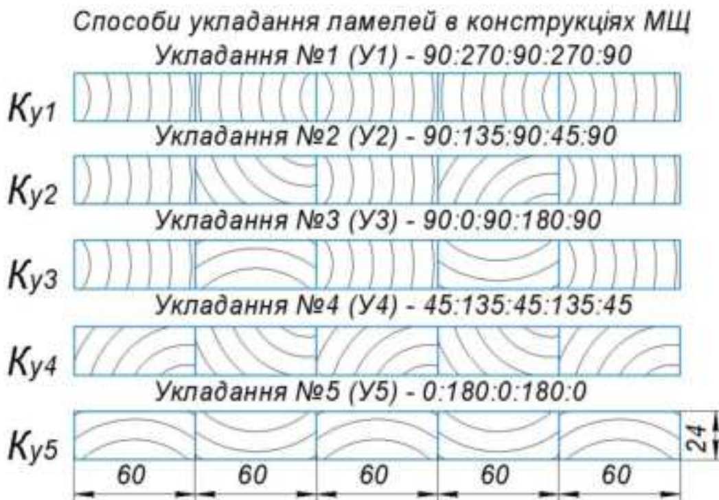
Рис. 2.3. Конструкції МЩ із деревини бука звичайного ( Fagus sylvatica L.) за способом укладання рейок
