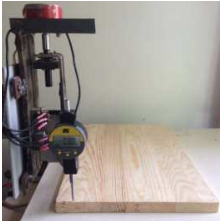
Рис. 3.1. Установка з числовим програмним управлінням для визначення стріли прогину (формостійкості) меблевих щитів
