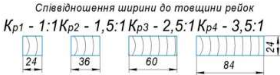
Рис. 2.1. Обгрунтовані та уніфіковані пропорційності розмірів в поперечному перерізі ламелі (ширина : товщина) в конструкціях меблевого щита із деревини бука звичайного ( Fagus sylvatica L.)
