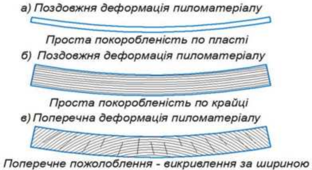
Рис. 1.9. Можливі види деформації пилопродукції
