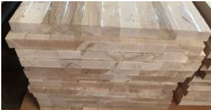
Рис. 3.6. Стопа некаліброваних меблевих щитів із деревини твердолистяних порід, зокрема бука на стелажах технологічної витримки
