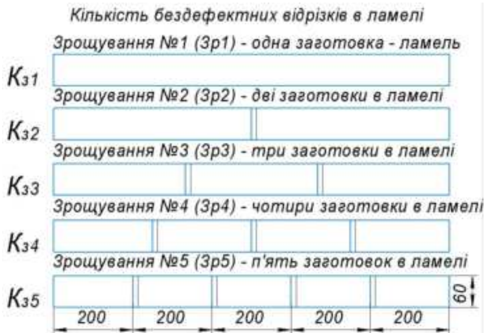
Рис. 2.4. Різновиди ламелей із бездефектних відрізків деревини в конструкціях МЩ із деревини бука звичайного ( Fagus sylvatica L.)
