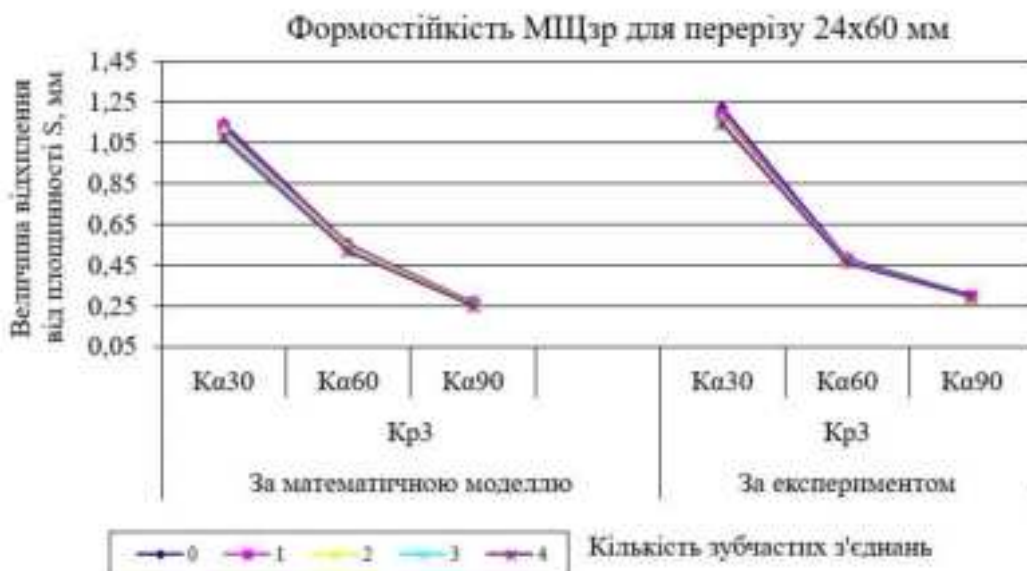
Рис. 4.25. Графічний лінійний порівняльний аналіз величин стріл прогину – відхилення від площинності за результатами експерименту та розрахунку за моделлю для рейок з різною кількістю зубчастих з'єднань перерізом 24×60 мм K_{p3} (співвідношення 1:2,5)
