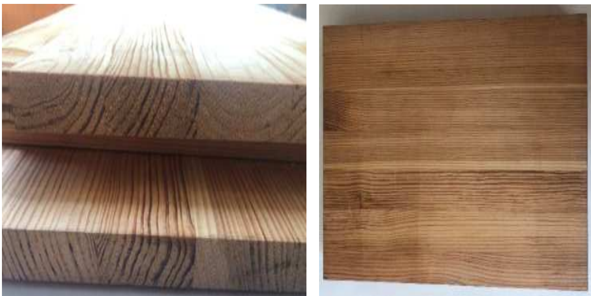
Рис. 3.4. Вигляди експериментальних зразків меблевих щитів із деревини шпилькових порід, зокрема сосни звичайної ( Pinus sylvestris )
