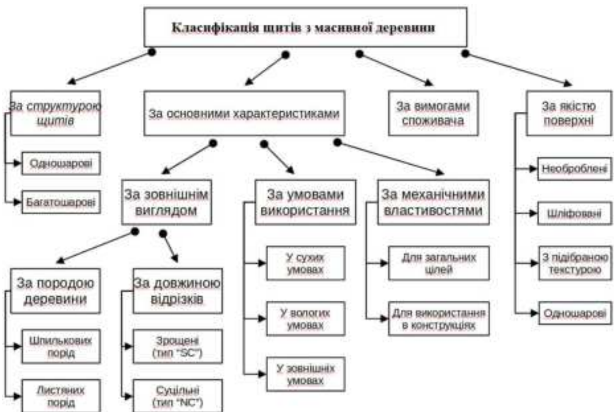
Рис. 1.7. Щити дерев'яні. Класифікація та термінологія (ДСТУ EN 12775:2004)
