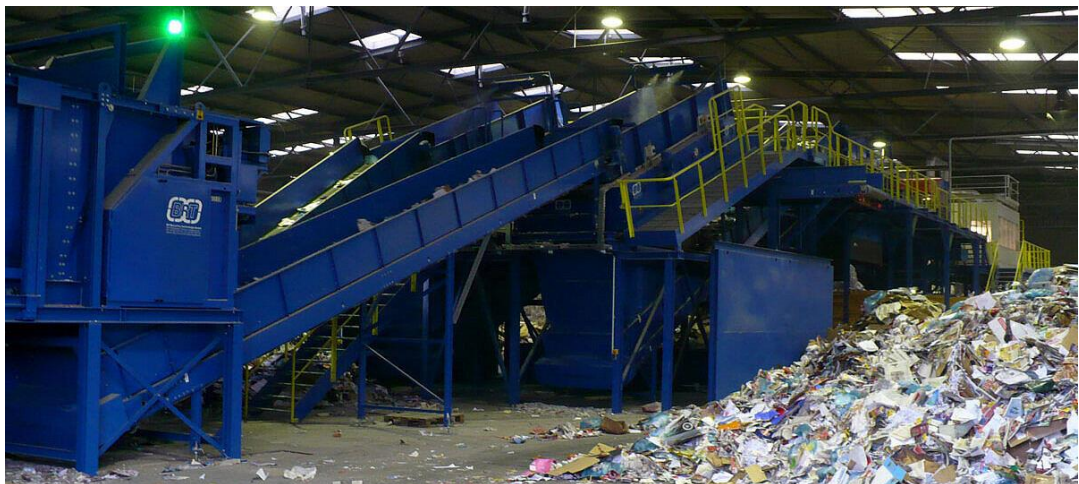
Рис. 2.5. Лінія сортування макулатури.
