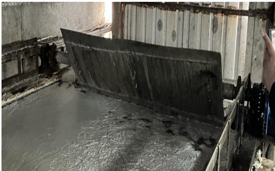
Рис. 4.2. Механізм відбору целюлози із використаної стічної води технологічним процесом виготовлення целюлози
