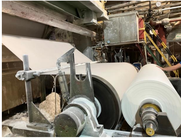
Рис. 2.3. Технологічна операція формування паперу у рулони.
