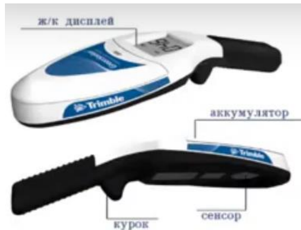
Рис. 1.5. Датчик для вимірювання біомаси рослин та урожайності.
