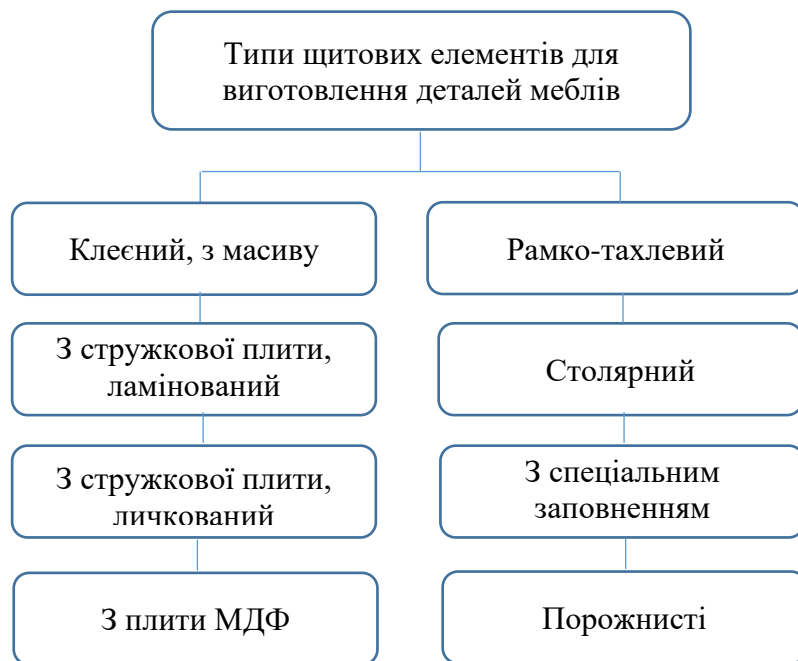
Рис. 1.3 Класифікація щитових елементів за конструктивними ознаками
