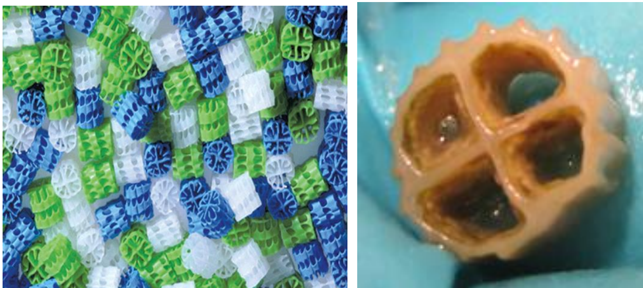
Рис. 4.2. Носій з біоплівкою у біоплівковому реакторі з рухомих шаром
