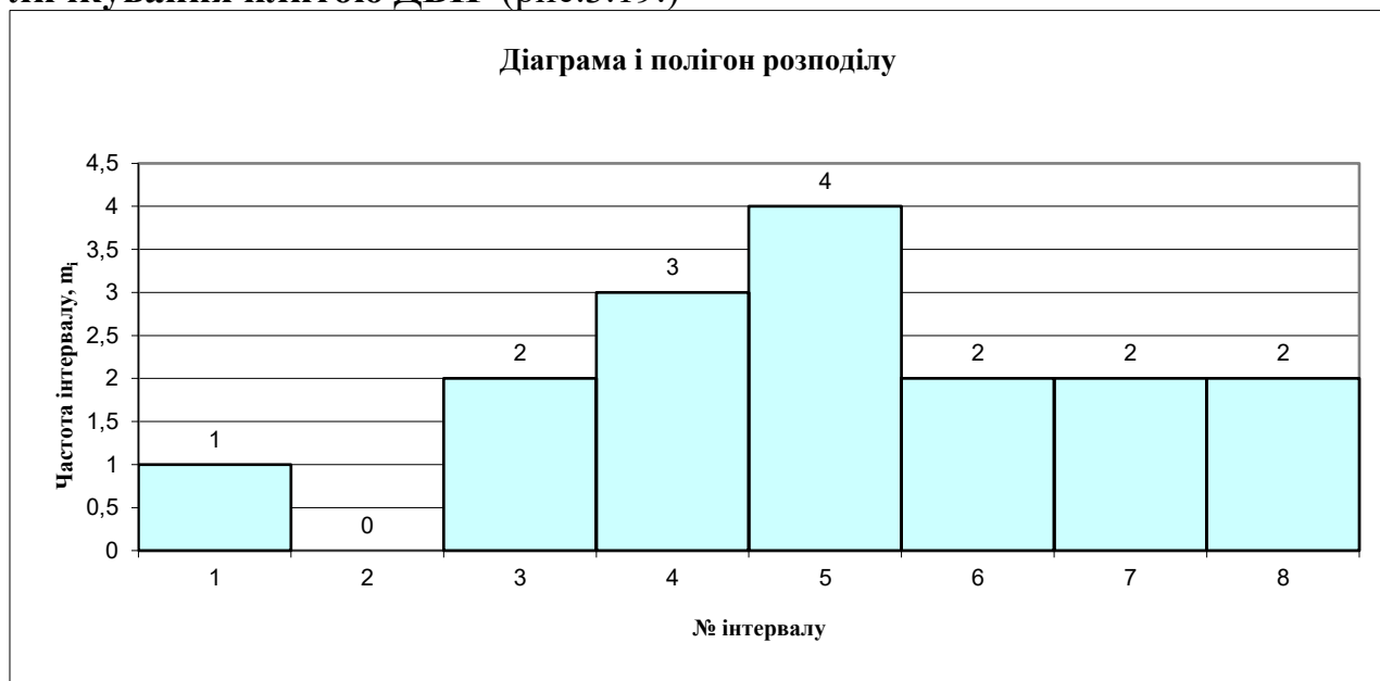
Рис. 3.19. Діаграма та Розподільчий полігон з інтервалами про дані випробування для встановлення межі міцності щитової конструкції – столярної плити , що була одержана процесом склеювання з використанням підготовлених брусків уніфікованих поперечних розмірів, зокрема ширина 42мм так званим, отриманої способом личкування плитою ДВП
