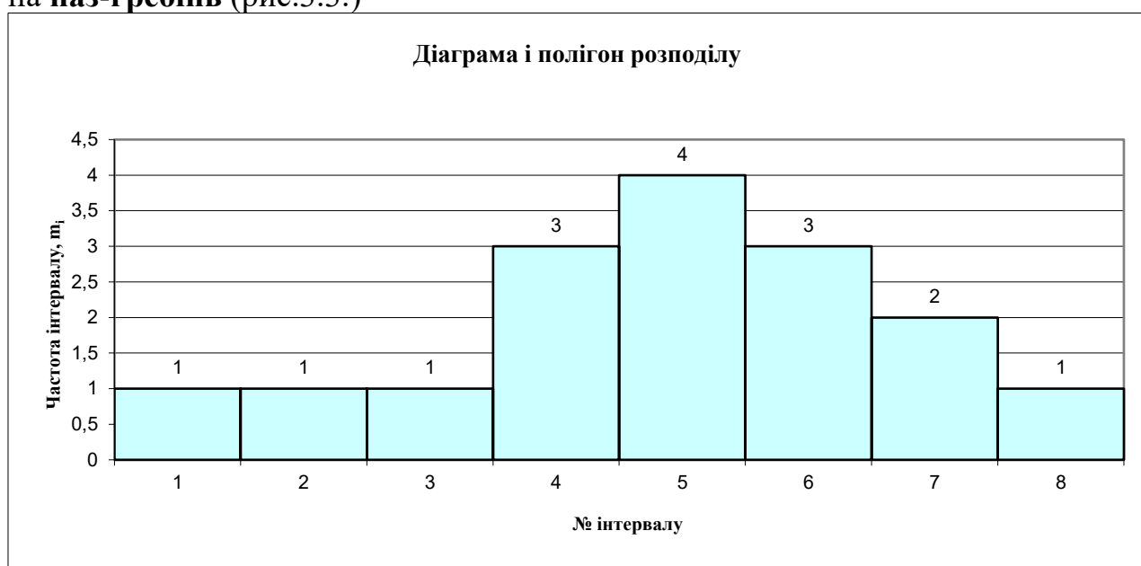
Рис. 3.3. Діаграма та Розподільчий полігон з інтервалами про дані випробування для встановлення межі міцності щитової конструкції столярного щита, щоб був одержаний процесом склеювання з використанням підготовлених брусків уніфікованих поперечних розмірів, зокрема ширина 42мм так званим способом на паз-гребінь
