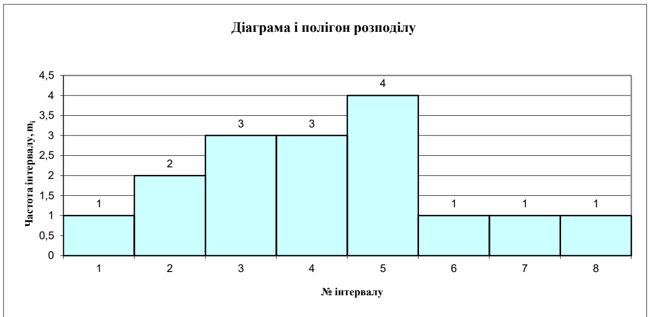
Рис. 3.9. Діаграма та Розподільчий полігон з інтервалами про дані випробування для встановлення межі міцності щитової конструкції – столярної плити , що була одержана процесом склеювання з використанням підготовлених брусків уніфікованих поперечних розмірів, зокрема ширина 42мм так званим, отриманої способом личкування фанерою
