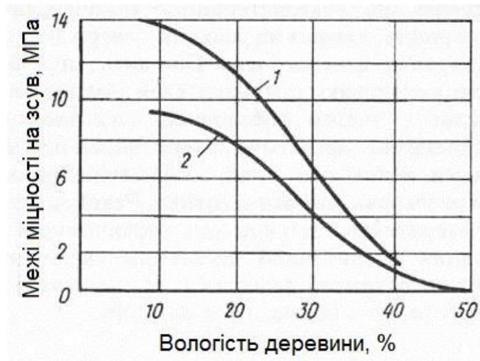
Рис. 3.4. Міцність клейового з'єднання деревини да дії вологи.
