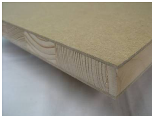
Рисун.: 1.2.3.1. Тип столярної плити у країнах ЄС Battenboard
