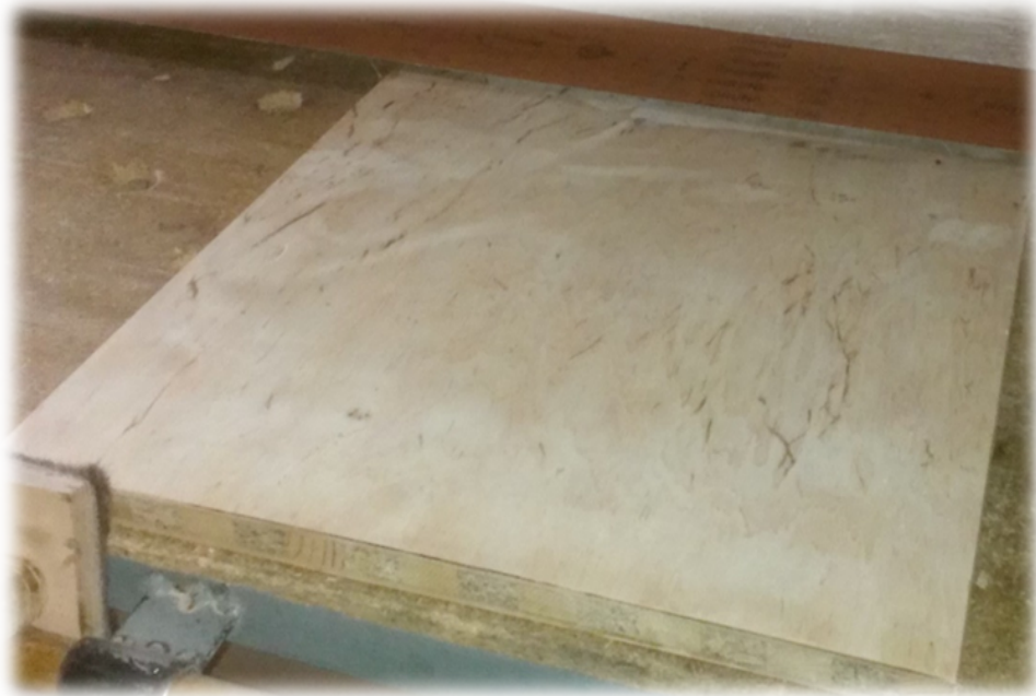
Рисун.: 3.1.17 Процес шліфування столярної плити із ВЖД
