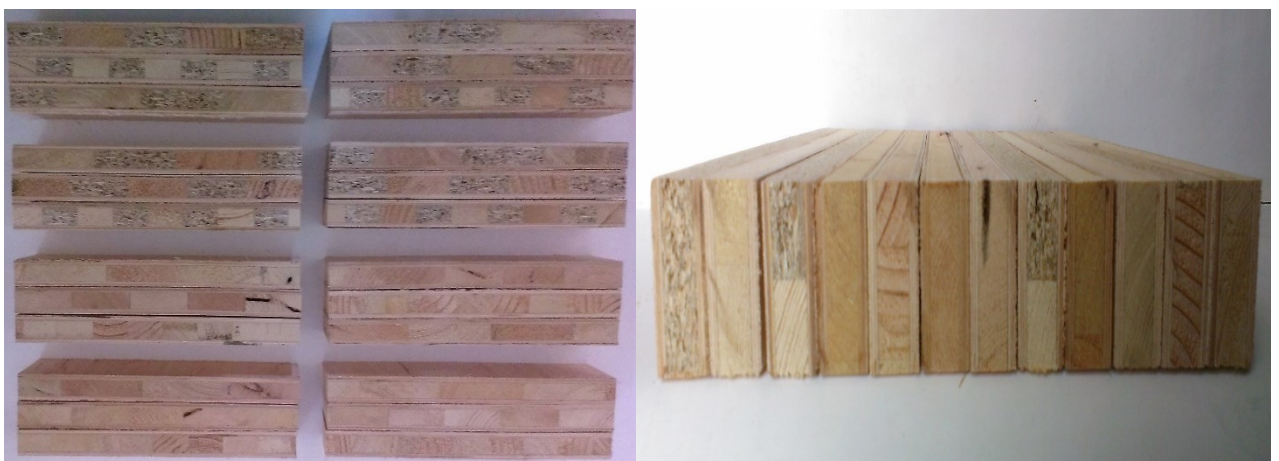
Рисун.: 2.2.1.2. Загальний вигляд експериментального зразка СП із ВЖД так і ВЖД (ДСП) різних конструкцій для випробовування показника міцності під час статичного згину впоперек рейок
