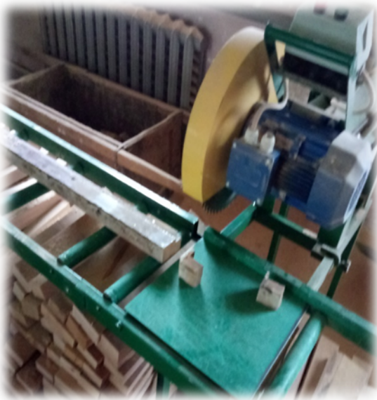
Рисун.: 3.1.6. Процес чорнового торцювання елементів дверних коробок
