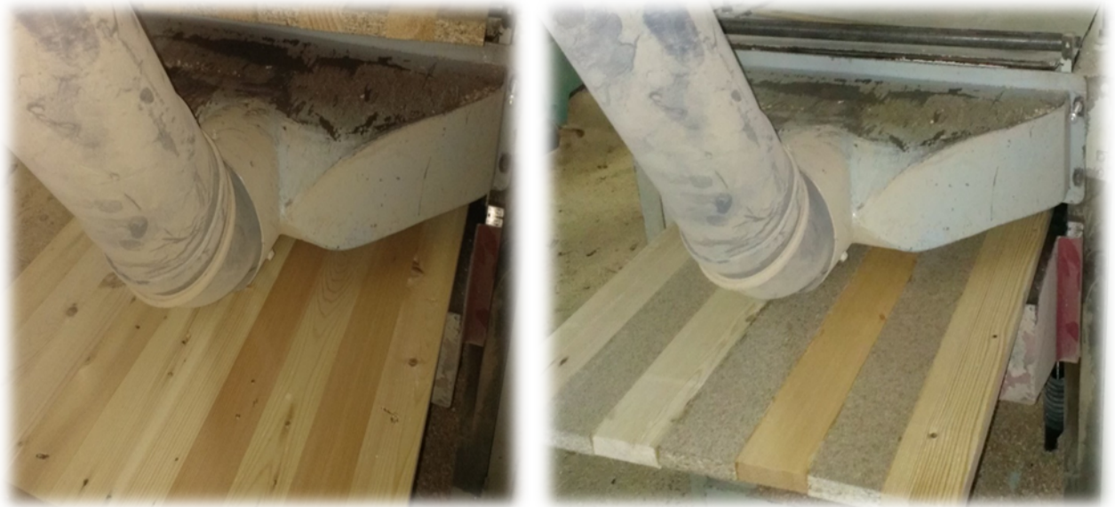
Рисун.: 3.1.14. Виконання операції стругання склеєних щитів за товщиною.
