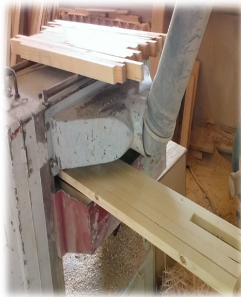
Рисун.: 3.1.11. Виконання операції стругання в розмір: а) за товщиною; б) за шириною.
