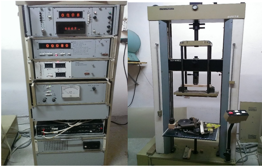
Рисун.:2.3.2.1. Випробувальна машина УММ – 5 (ГОСТ 7855 -61)
