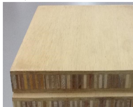
Рисун.: 1.2.3.3. Тип столярної плити у країнах ЄС Laminboard
