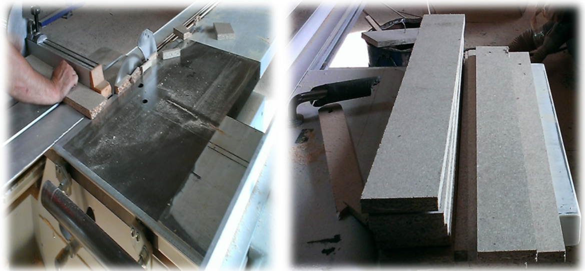
Рис 3.1.12. Розкрій ДСП за довжиною а) і шириною б)
