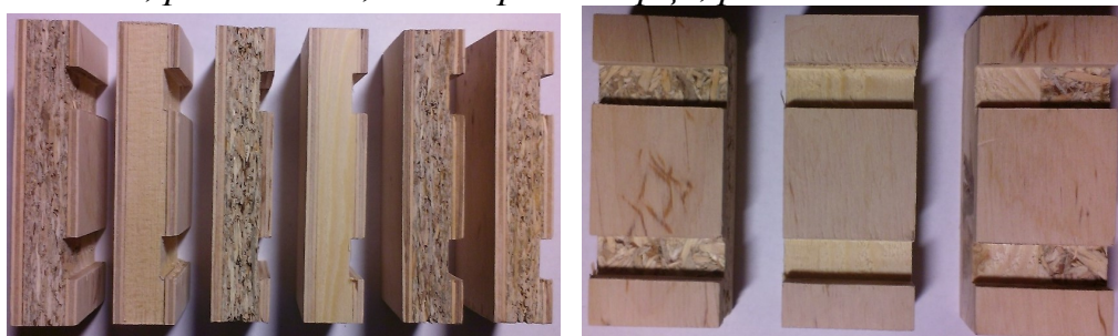
Рисун.: 2.2.2.2. Загальний вигляд експериментального зразка СПіз ВЖД так і ВЖД (ДСП) різних конструкцій для випробовування границі показника міцності під час сколювання вздовж клейового прошарку в сухому стані
