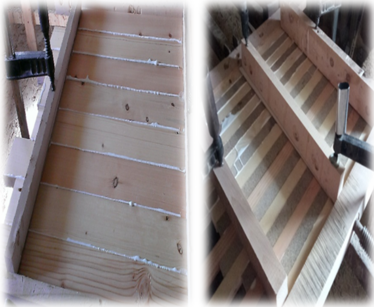
Рисун.: 3.1.13. Процес нанесення клею П-ВА моделі «J-o-w-a-t 1.0.3.0.5» а); зрошення першого типу щита б); та другого типу щита в)
