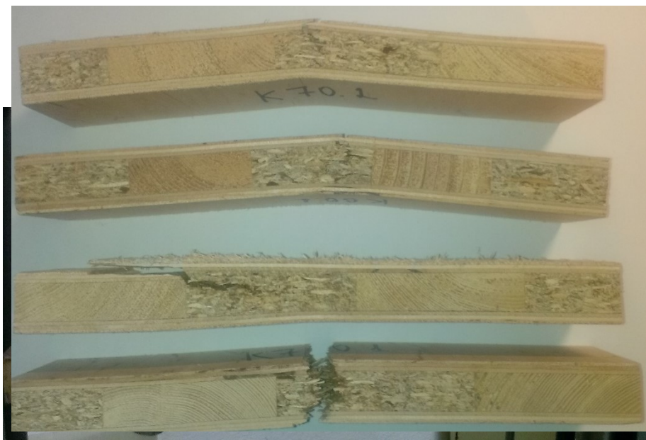
Рисун.: 3.2.2.1.5. Зразок комбінованої СП(Брусок-ДСП)ВЖД під навантаженням та в момент руйнування
