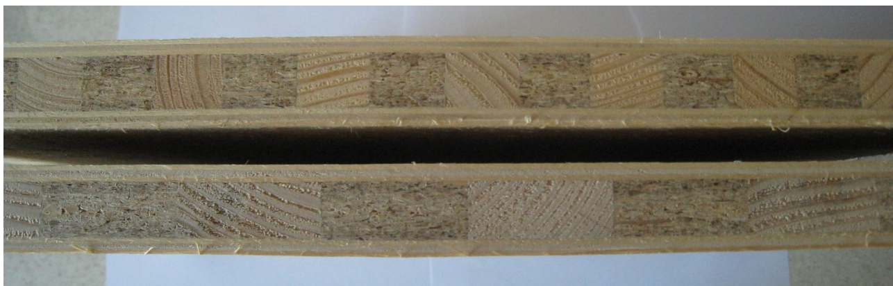
Рисун.: 2.2.3.1. Загальний вигляд експериментального зразка столярної плити, виготовленого із ВЖД (масив) так і ВЖД (ДСП) різних конструкцій
