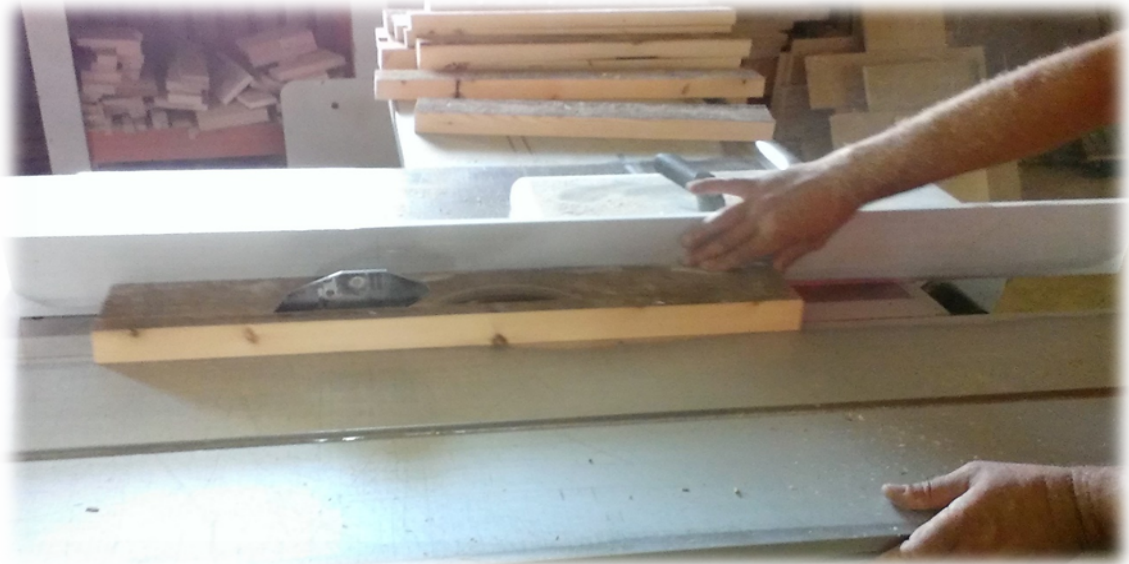
Рисун.: 3.1.10. Розкрій чорнових заготовок за шириною
