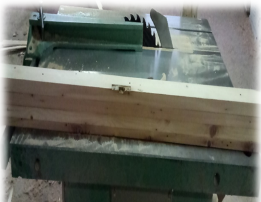
Рисун.: 3.1.7. Процес розкрою дверних коробок по товщині
