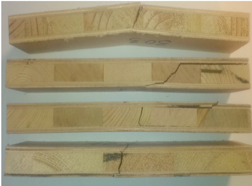
Рисун.: 3.2.2.1.3. Взірець личкової фанерою Столярної лабораторної плити з щитом з вживаної деревини після випробування
