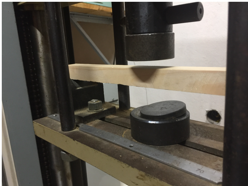
Рис. 3.9. Проведення експерименту на статичний згин
