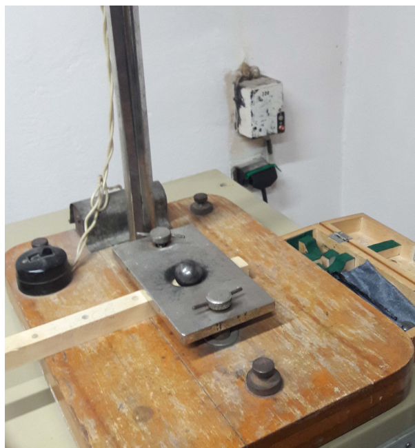
Рис. 3.5. Проведення експерименту на ударну твердість
