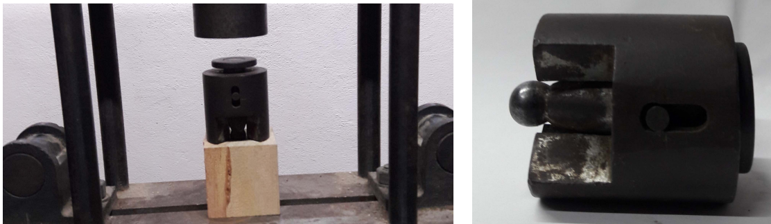
Рис. 3.7. Проведення експерименту на статичну твердість
