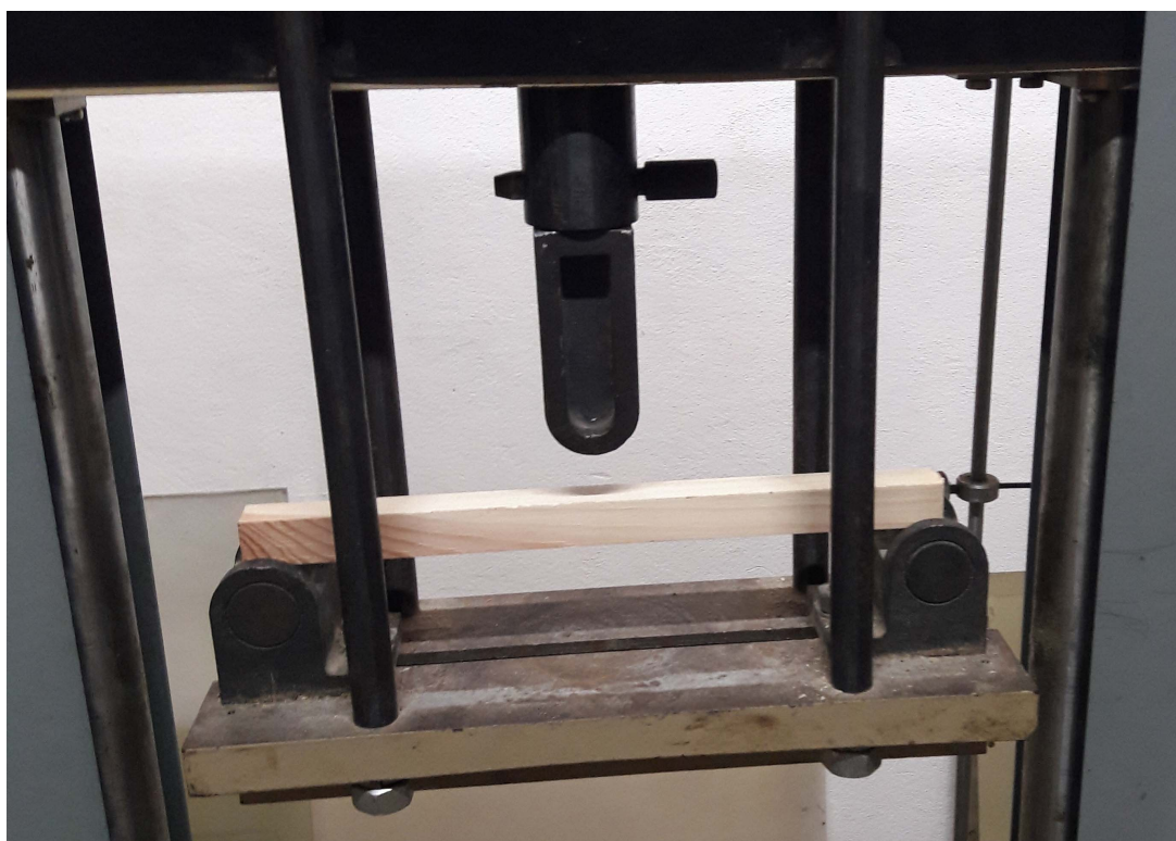
Рис. 3.10. Лабораторний експеримент на міцність на статичний згин
