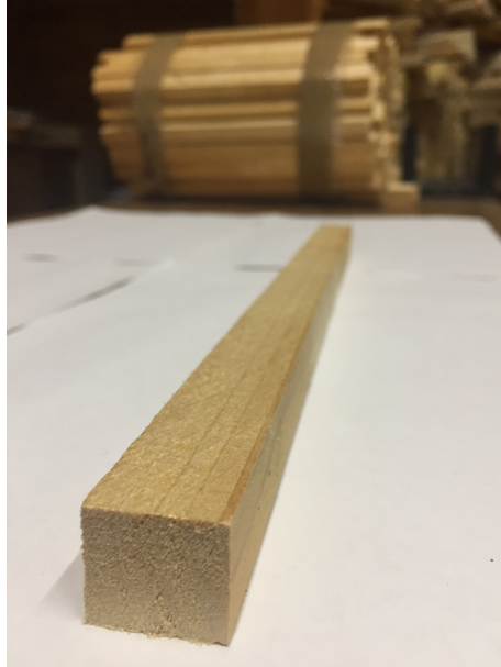
Рис. 3.1. Сформовані погонажні бруски для нарізання взірців
