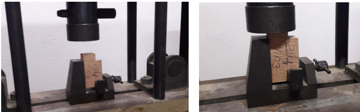
Рис. 3.12. лабораторний експеримент на міцність при сколюванні
