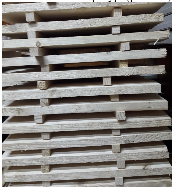
Рис 3.2. Витримування рейок при кімнатній температурі
