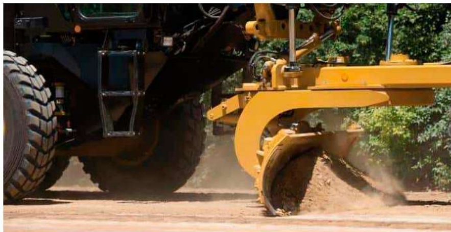
Рисунок 1.6 – Повертання тягової рами автогрейдера за допомогою гідравлічних циліндрів
