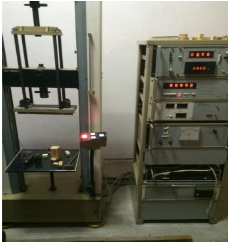
Рис. 2.5 Розривна машина ИР 5057-50.
