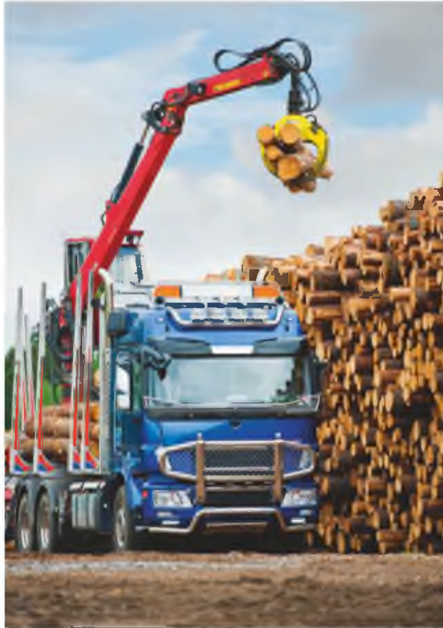
Рисунок 1.1 – Використання маніпулятора Hiab Loglift 96S для навантаження й розвантаження штучних і пакетованих вантажів.
