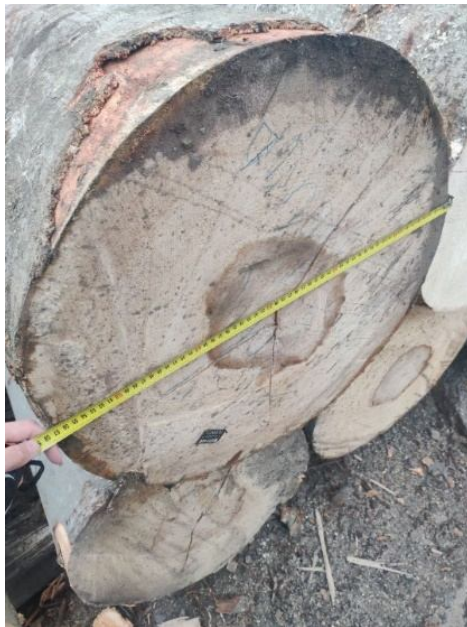
Рис 1.12 Вимірювання діаметра колод по горизонталі
