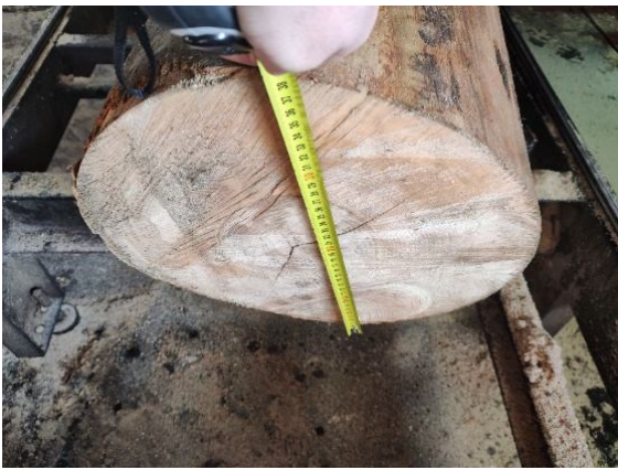
Рис 2.3 Вимірювання відземкового діаметра по горизонталі
