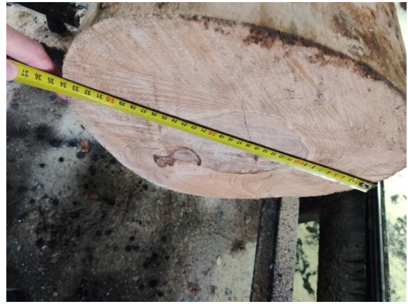
Рис 2.2 Вимірювання вершинного діаметра по вертикалі
