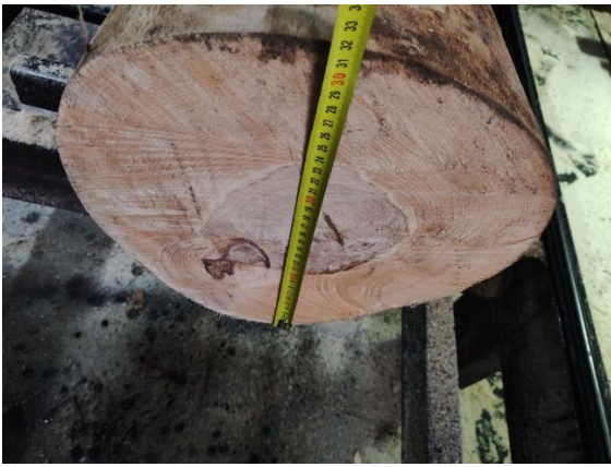
Рис 2.1 Вимірювання вершинного діаметра по горизонталі
