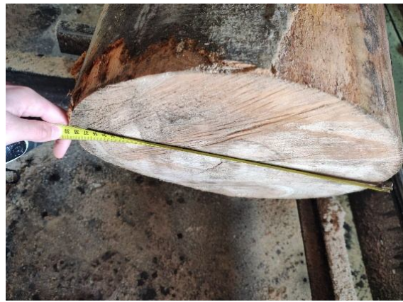
Рис 2.4 Вимірювання відземкового діаметра по вертикалі
