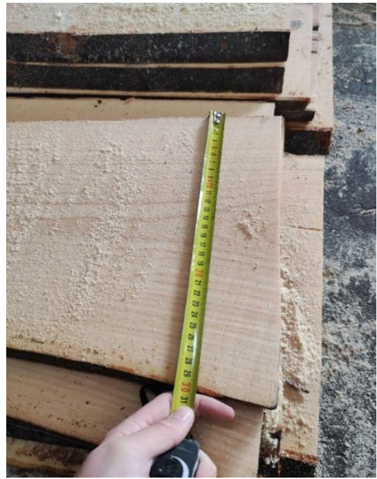
Рис 2.6 Вимірювання ширини дошки у верхині Рис 2.7 Вимірювання ширини дошки у відземку
