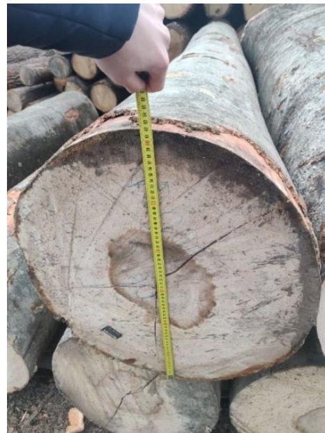
Рис 1.13 Вимірювання діаметра колод по вертикалі
