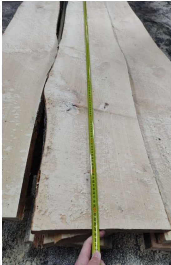
Рис. 2.5 Вимірювання довжини дошки
