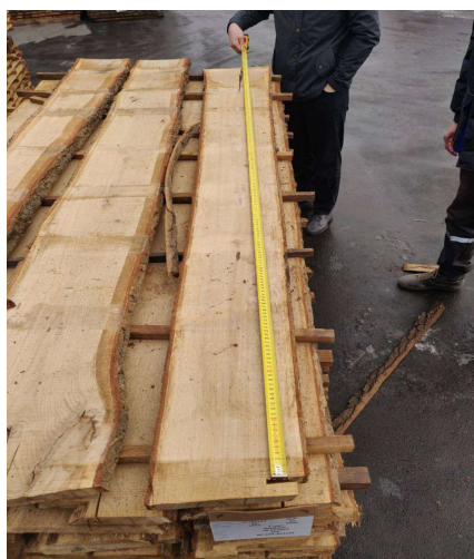
Рис 2.7 – Вимірювання довжини пиломатеріалу № 1
