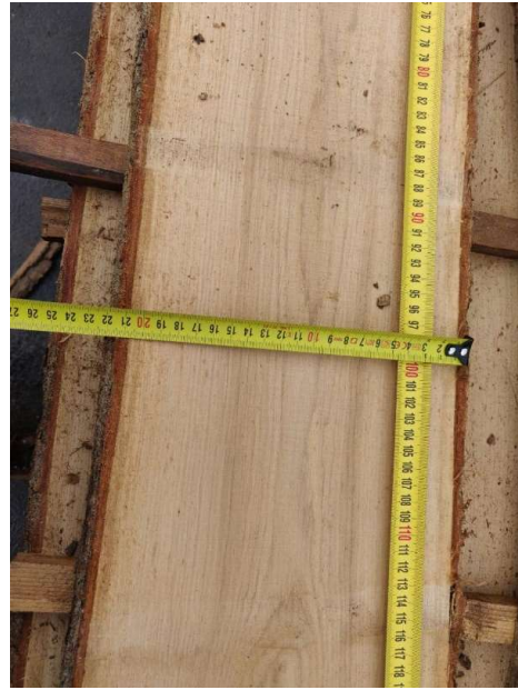
Рис 2.4 – Вимірювання ширини пиломатеріалу на середині його довжини № 1: а – внутрішня пласть; б – зовнішня пласть
