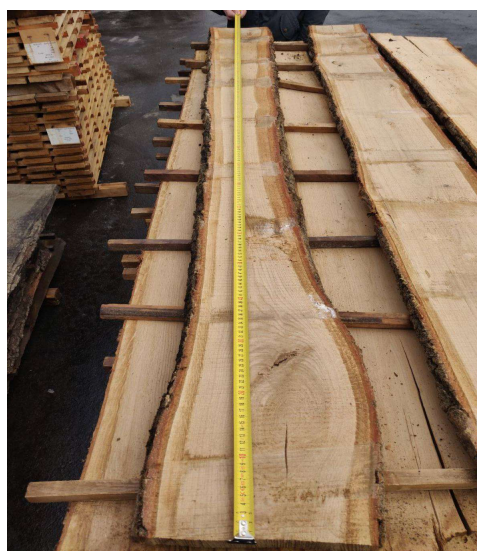
Рис 2.9 – Вимірювання довжини пиломатеріалу № 3
