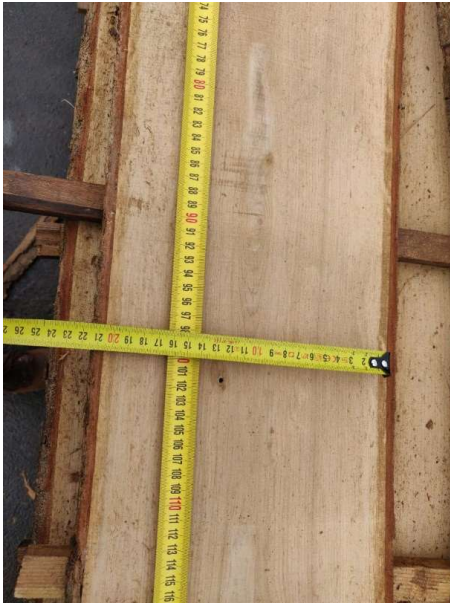
Рис 2.4 – Вимірювання ширини пиломатеріалу на середині його довжини № 1: а – внутрішня пласть; б – зовнішня пласть
