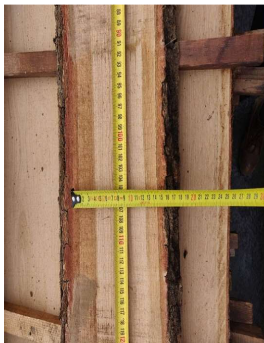
Рис 2.6 – Вимірювання ширини пиломатеріалу на середині його довжини № 3: а – внутрішня пласть; б – зовнішня пласть
