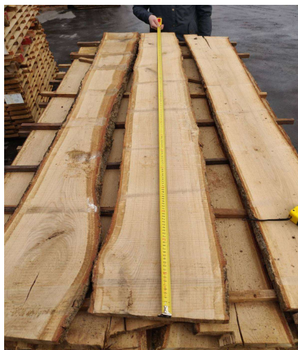
Рис 2.8 – Вимірювання довжини пиломатеріалу № 2
