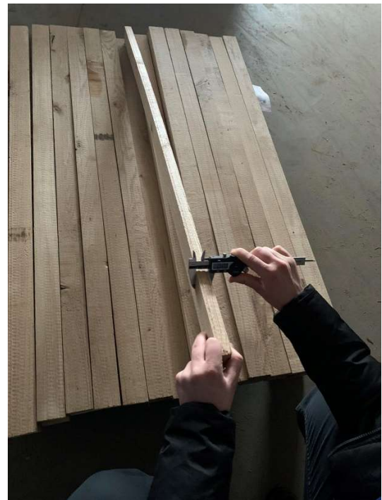
Рис 2.17 – Вимірювання ширини та товщини заготовки № 2:
