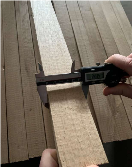
Рис 2.6 – Вимірювання ширини та товщини заготовки № 1:
