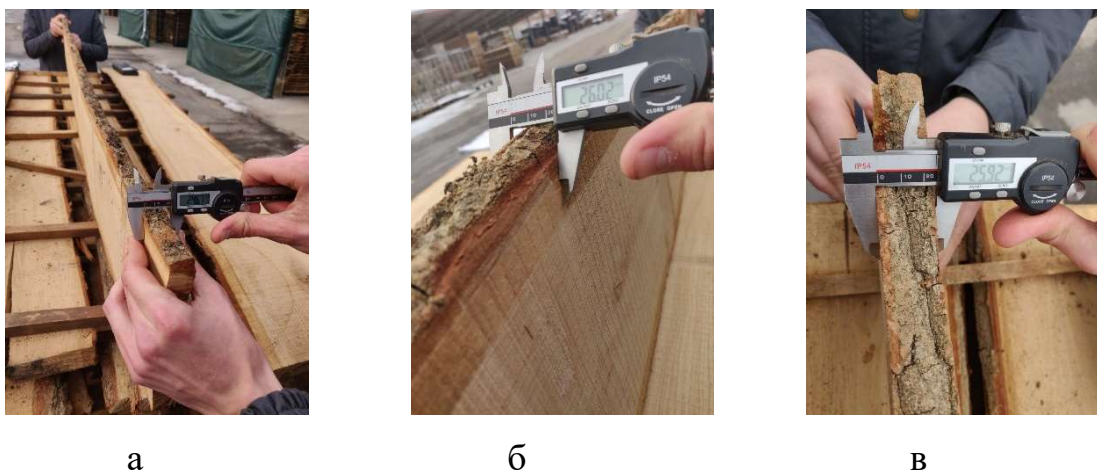
Рис 2.2 – Вимірювання товщини пиломатеріалу № 2: а – відземок, б – середина, в – вершина
