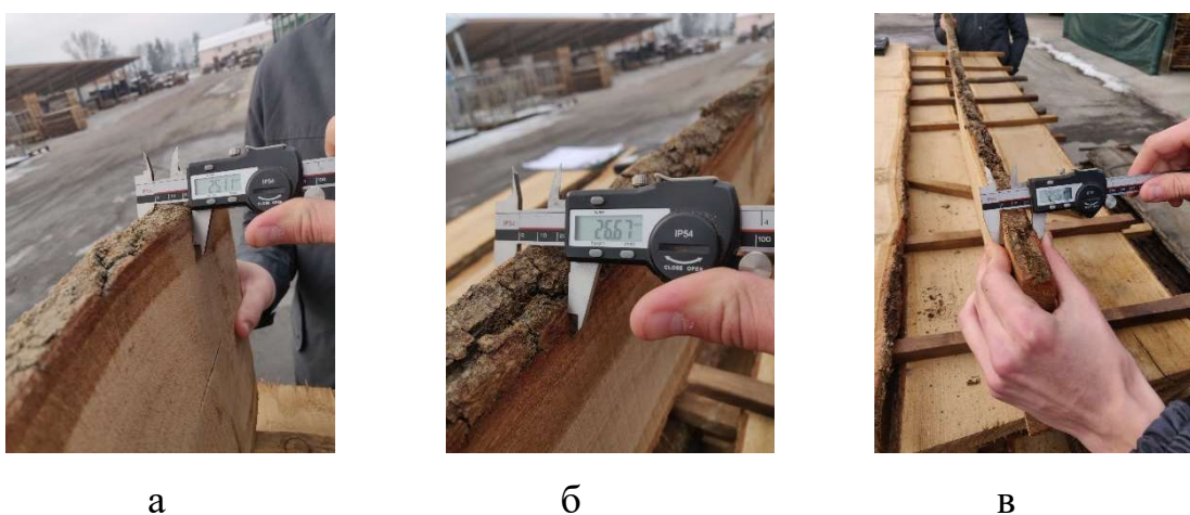
Рис 2.3 – Вимірювання товщини пиломатеріалу № 3: а – відземок, б – середина, в – вершина
