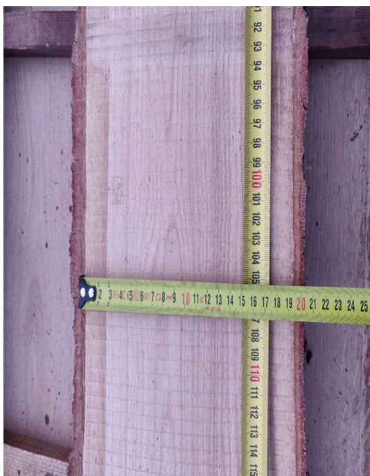
Рис 2.6 – Вимірювання ширини пиломатеріалу на середині його довжини № 3: а – внутрішня пласть; б – зовнішня пласть
