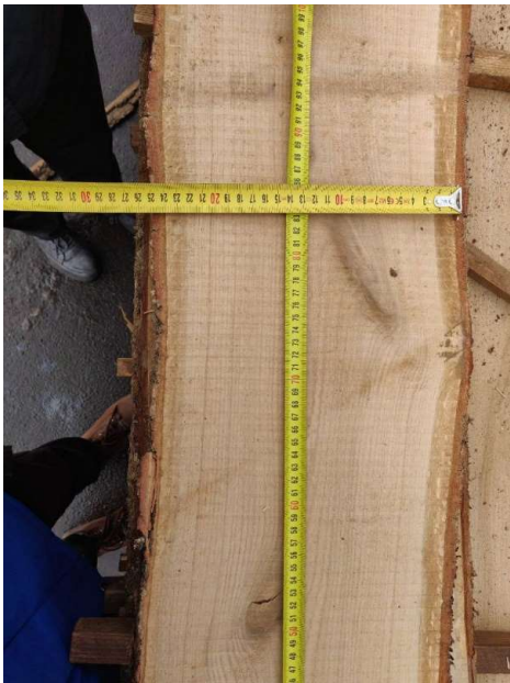
Рис 2.4 – Вимірювання ширини пиломатеріалу на середині його довжини № 1: а – внутрішня пласть; б – зовнішня пласть
