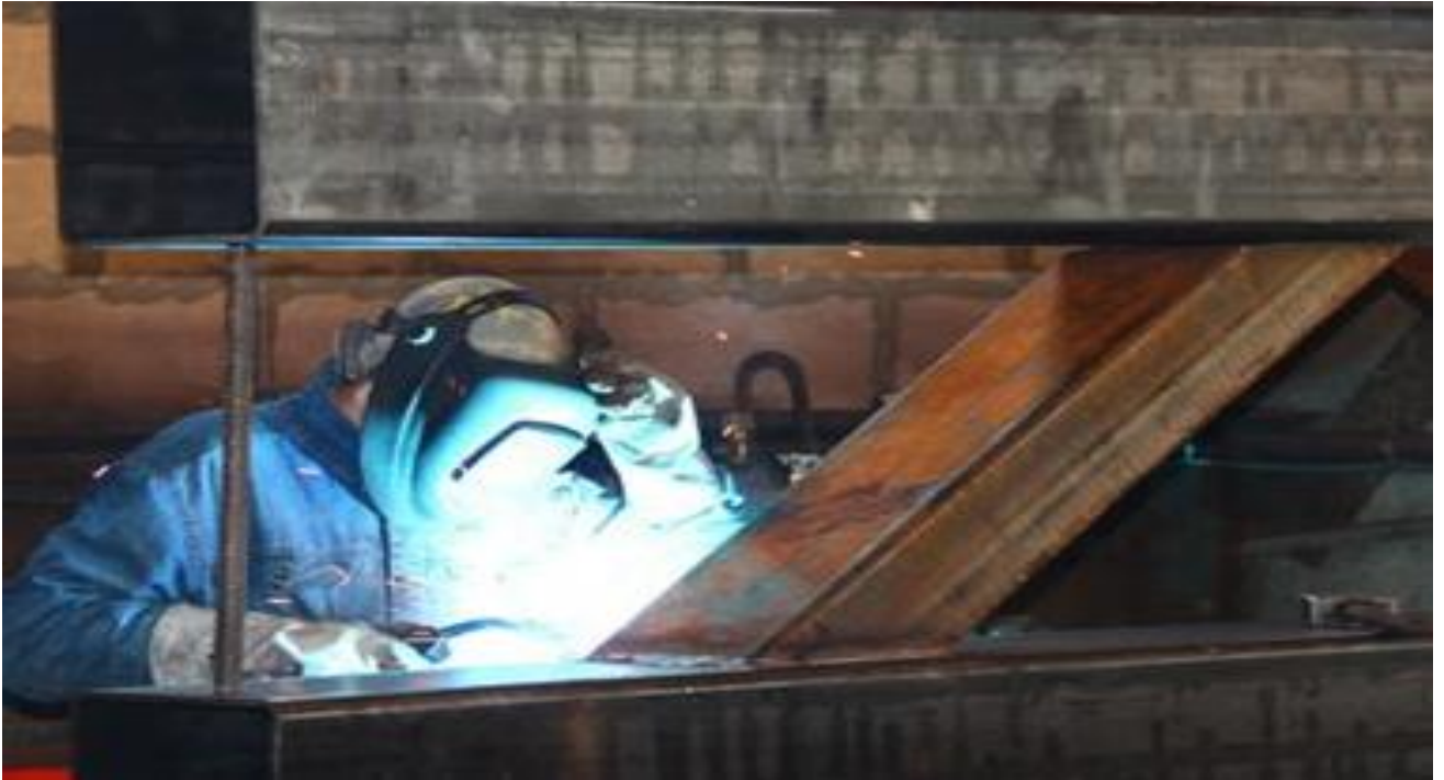
Рисунок 1.6 – Момент процесу ручного зварювання з накладанням кутового шва.
