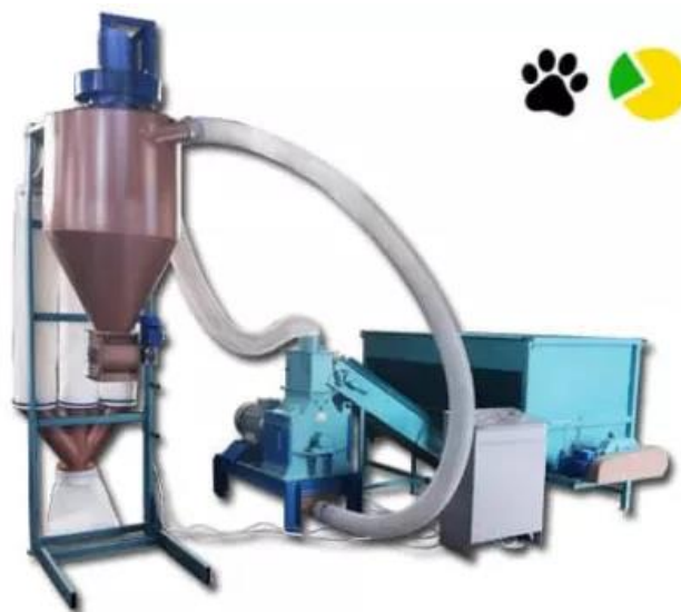
Рис. 3.6. Дробарка для подрібнення відходів деревини.
