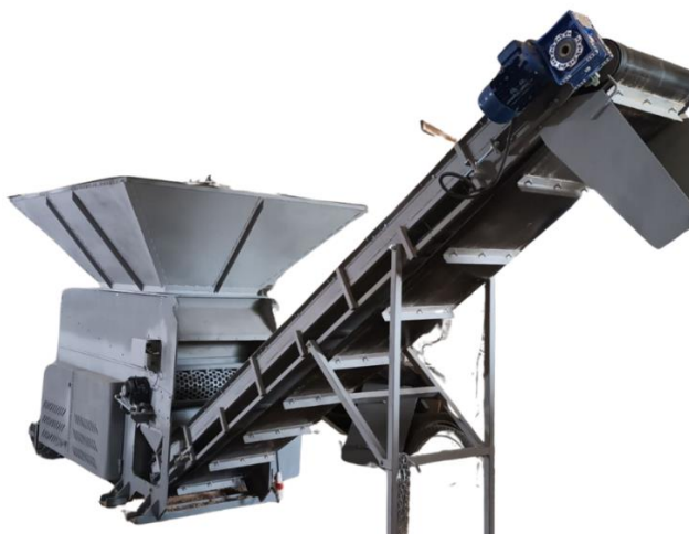
Рис. 3.2. Дробарка для подрібнення кускових відходів деревини.
