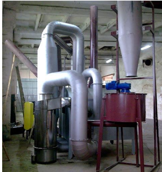
Рис. 4.3. Вентиляційна система при виготовленні паливних брикетів.
