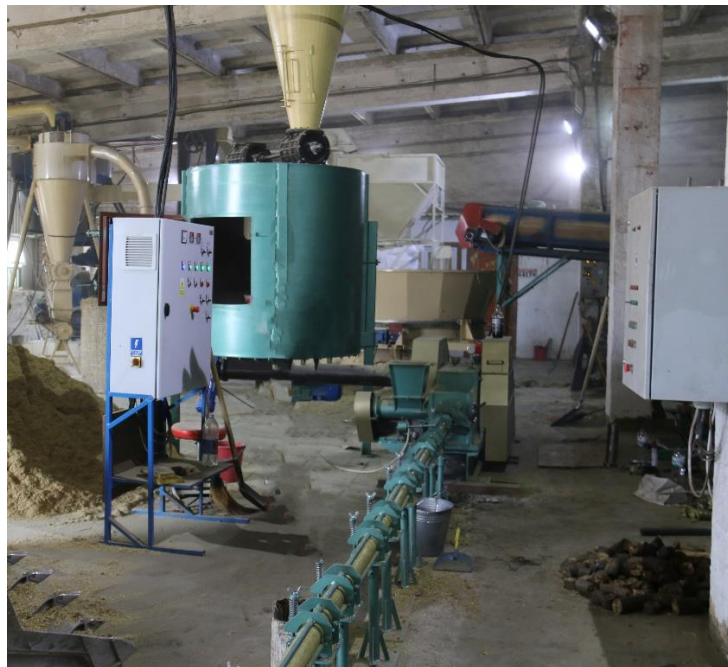
Рис. 4.4. Вентиляційна система під час пресування паливних брикетів.
