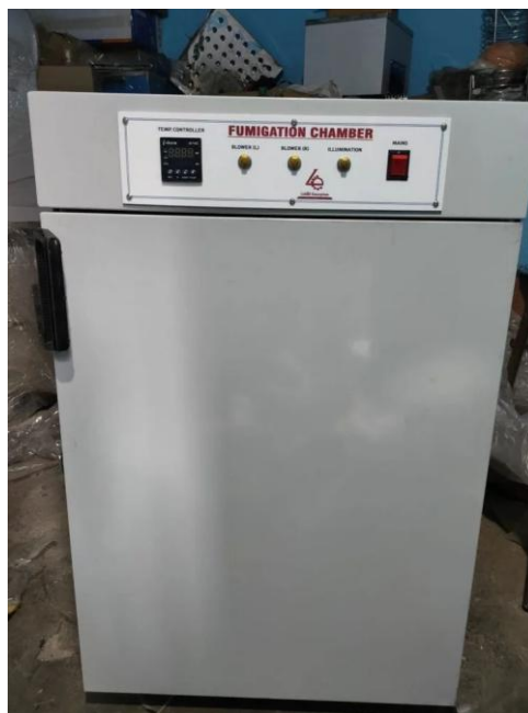
Рис.1.5. Лабораторна фумігаційна камера із панеллю керування температурою. Джерело: Labsol Fumigation Chamber [21]
