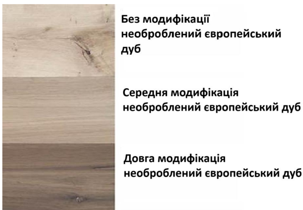
Рис.1.4. Зміна кольору дубової деревини при аміачному фумінгу: необроблений зразок, злегка затемнений і сильно затемнений. [20]
