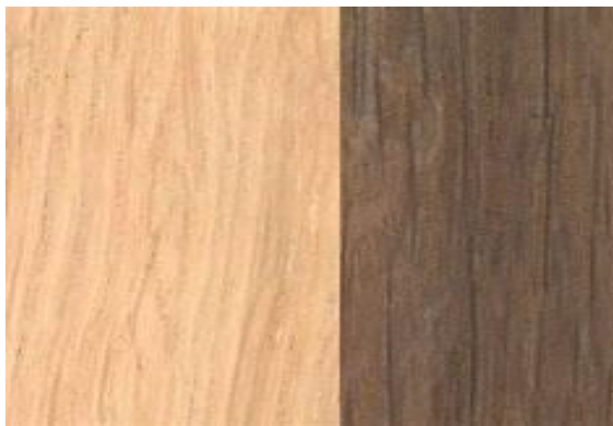
Рис.1.3 Зміна кольору дубової деревини через аміачну обробку: необроблений зразок (ліворуч) і оброблений (праворуч). [19]
