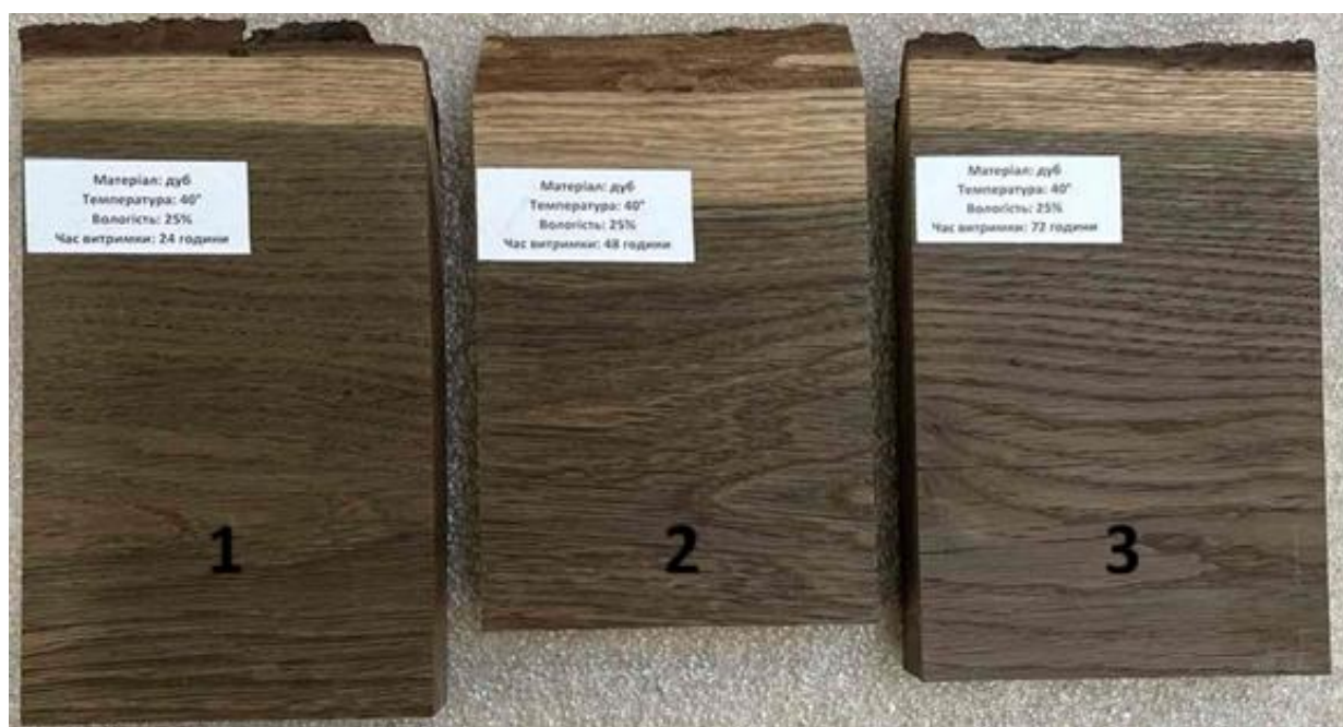
Рис.3.3 Глибина проникнення кольору за температури t=40^{\circ}\text{C} , вологості W=50\% та тривалості обробки взірець 1 – \tau=24 год.; взірець 2 – \tau=48 год. взірець 3 – \tau=72 год.
