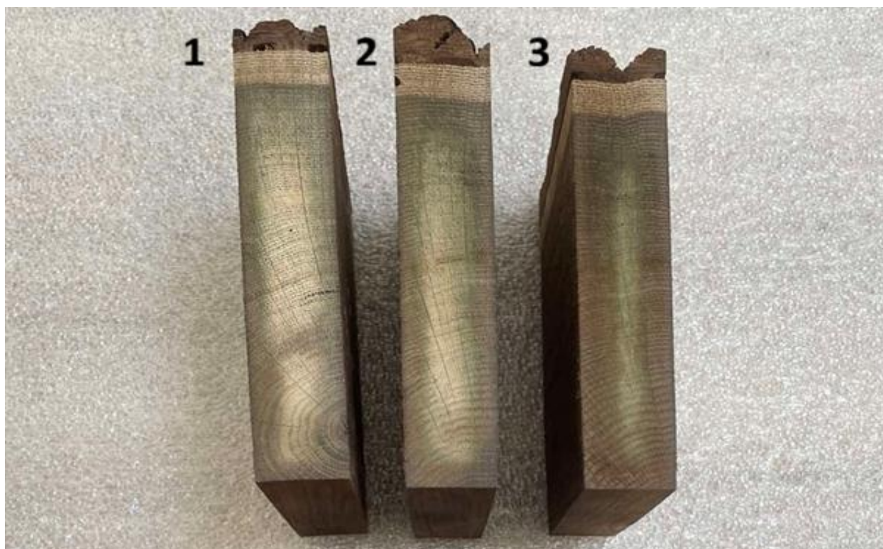
Рис.3.3 Глибина проникнення кольору за температури t=40^{\circ}\text{C} , вологості W=50\% та тривалості обробки взірець 1 – \tau=24 год.; взірець 2 – \tau=48 год. взірець 3 – \tau=72 год.
