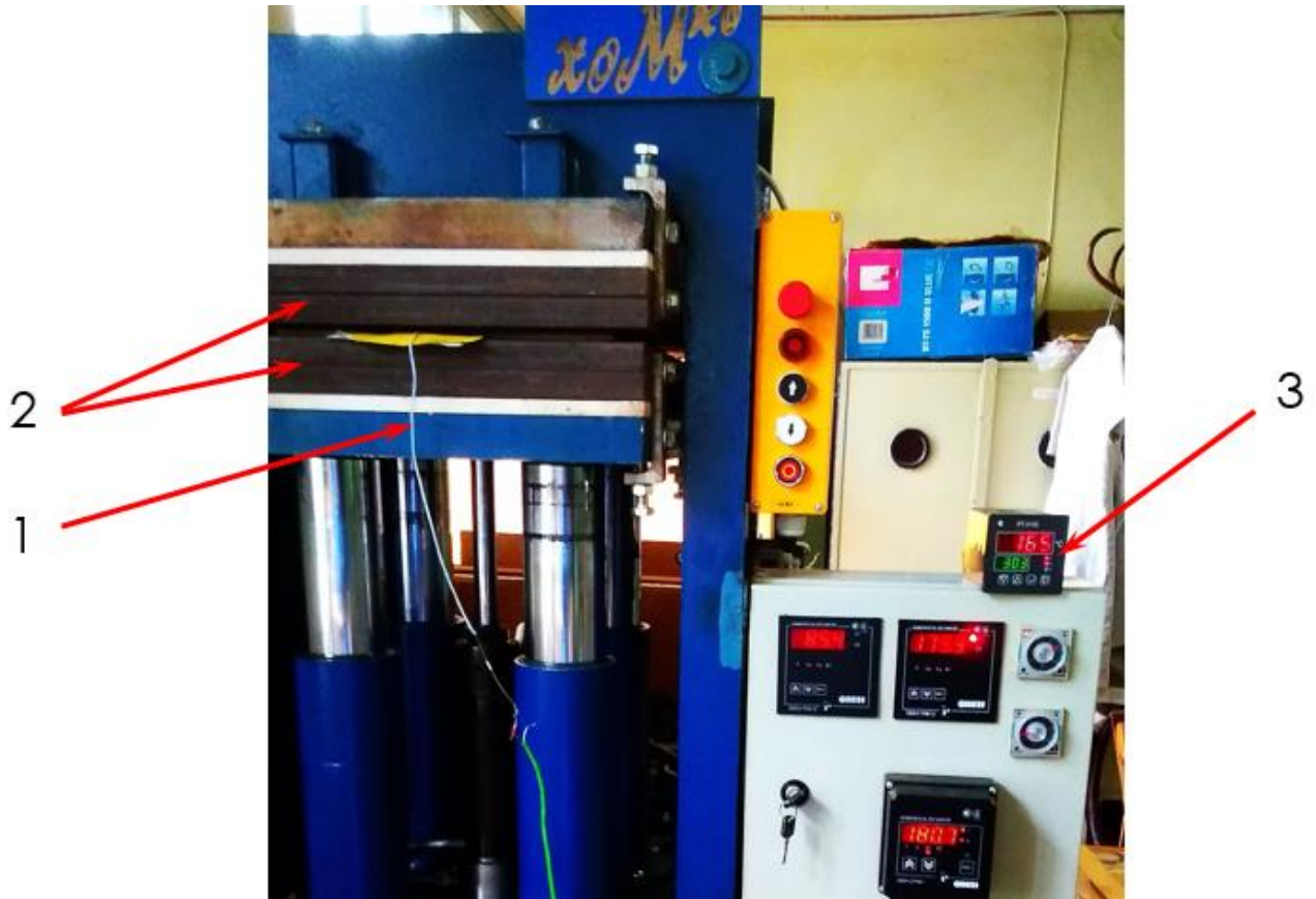
Рис. 2.8. Робочий момент визначення температури прогрівання пакета шпону:
