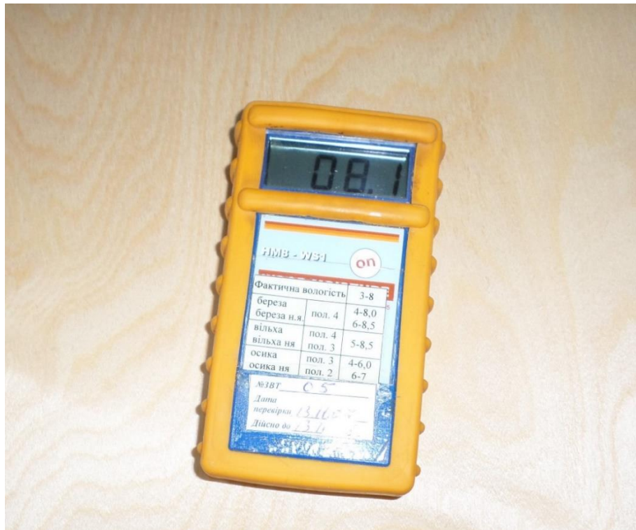
Рис. 2.4. Робочий момент визначення вологості лущеного шпону
