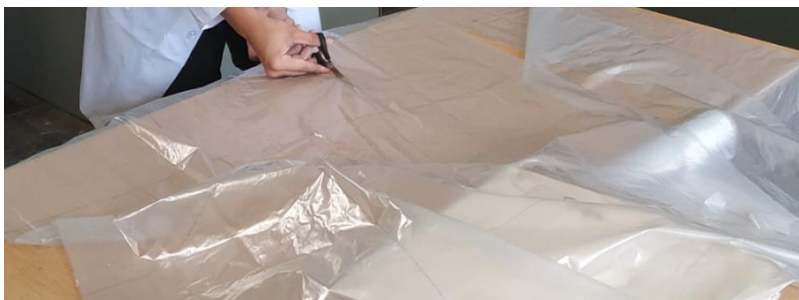
Рис. 2.5. Робочий момент розкроявання плівки ППЕНГ
