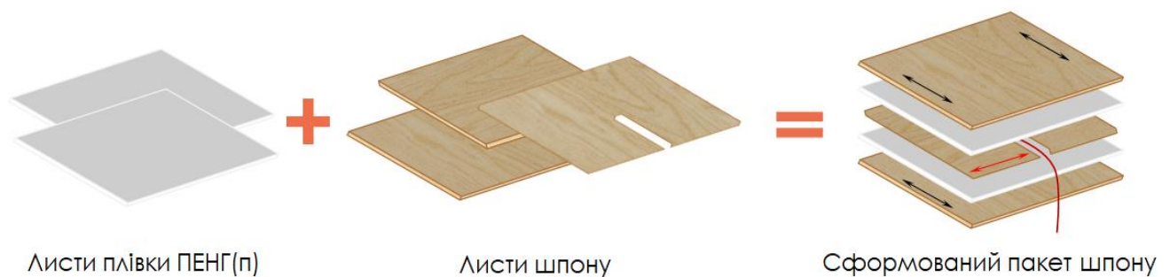
Рис. 2.6. Схема формування пакета шпону
