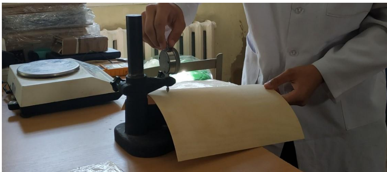
Рис. 2.3. Робочий момент визначення товщини шпону
