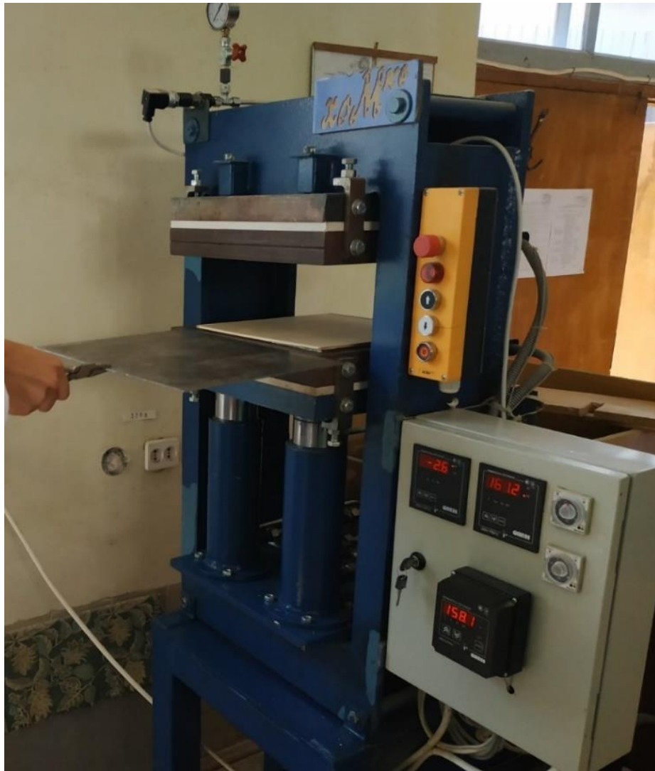
Рис. 2.7. Робочий момент закладання пакета шпону в лабораторний прес "Хомко"
