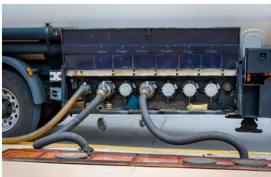
Рис. 3.1. Злив світлих нафтопродуктів з автоцистерн в підземні резервуари
