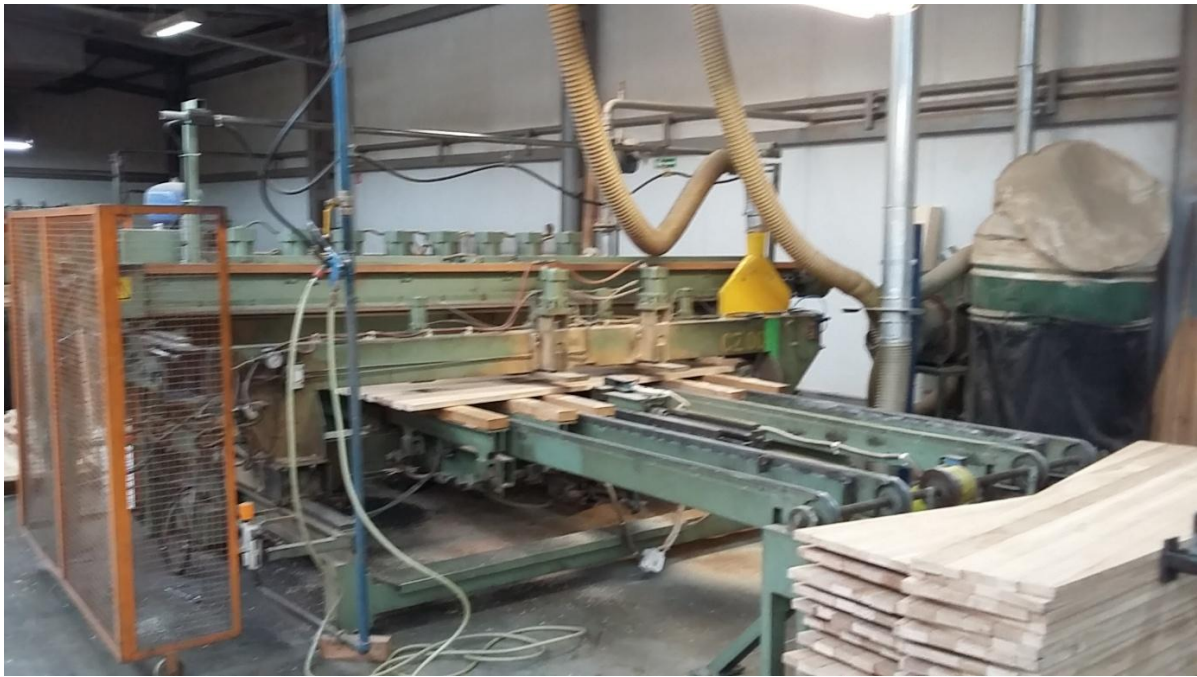
Рисунок 1.2. Загальний вигляд клеєних щитів після формування необхідного розміру за шириною після виходу з безперервного пресадля фірми Weining.
