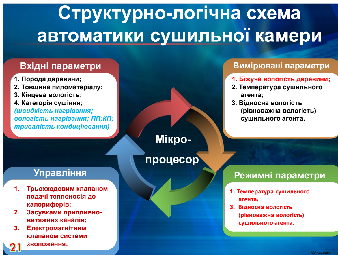
Рисунок 2.9. Структурно-логічна схема роботи автоматичної системи контролю і управління конвективною сушильною камерою MS-201.
