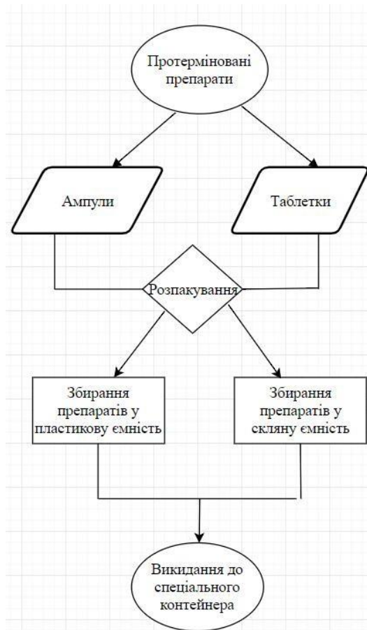
- Рис. 3.1. Схема послідовності дій для забезпечення подальшої утилізації протермінованих фармацевтичних препаратів з різним упакуванням
