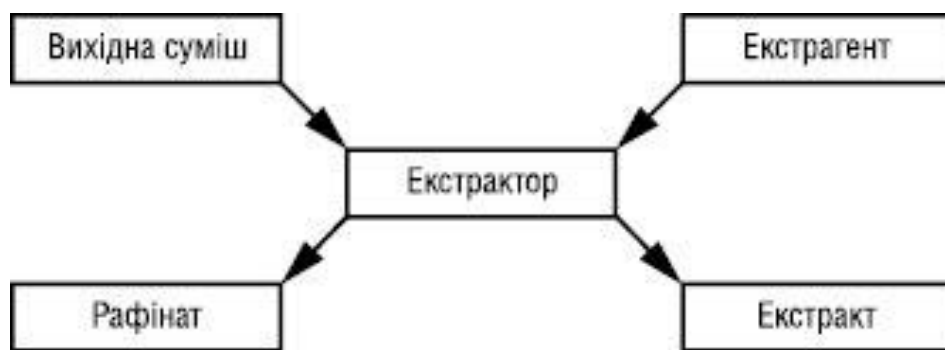
Рис. 4.4. Схематичне зображення потоків процесу екстракції
