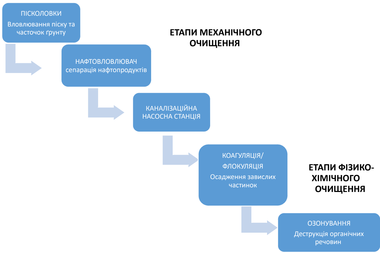
Рис. 30. Пропонована технологічна схема, яку можна впроваджувати на автоматизованих станціях самообслуговування для очищення стічних вод перед скидом у каналізаційні міські мережі
