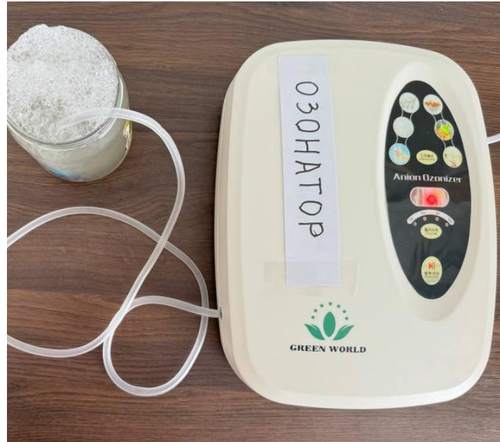
Рис. 13. Озонатор, який використовувався для очищення проб стічної води автомийних станцій
