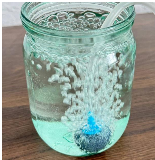
Рис. 14. Процес утворення бульбашок озону під час методу озонування
