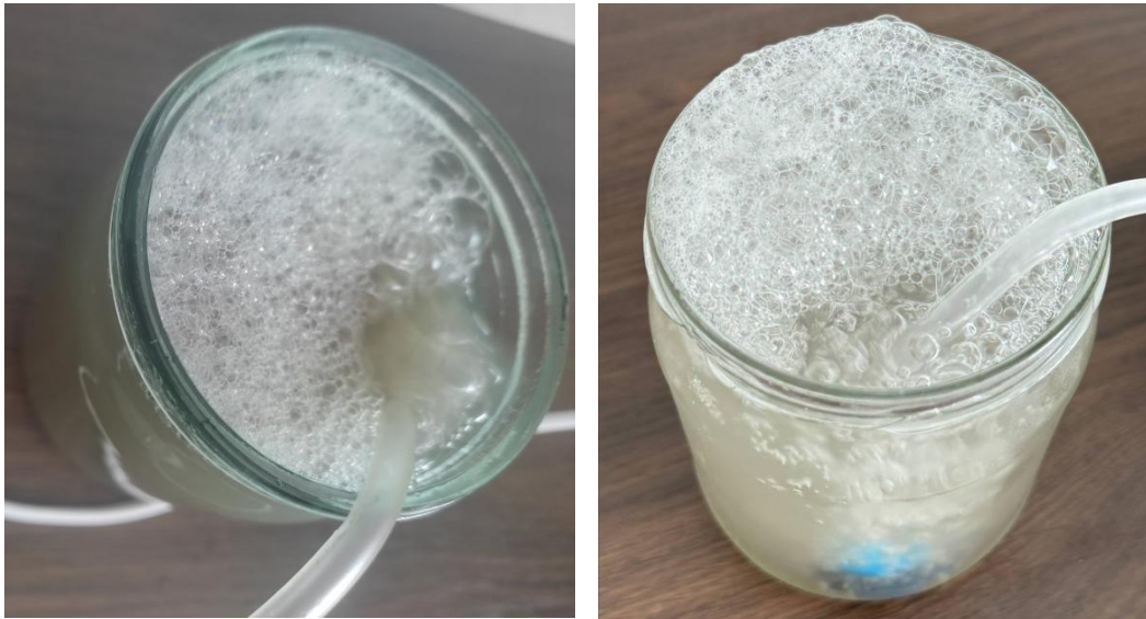
Рис. 15. Утворення великої кількості піни у зразках стічних вод із різних колодязів при проведенні озонування
