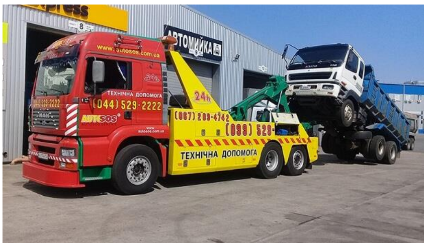
Рисунок 1.4 – Процес евакуації автомобіля самоскида за передню вісь.
