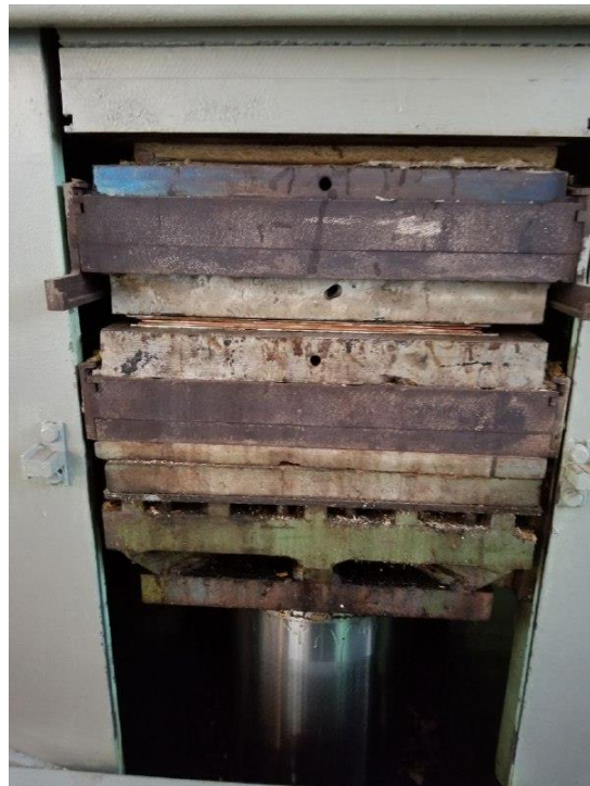
Рисунок 2.4. Пресування пакету в пресі марки ПГ-160-400
