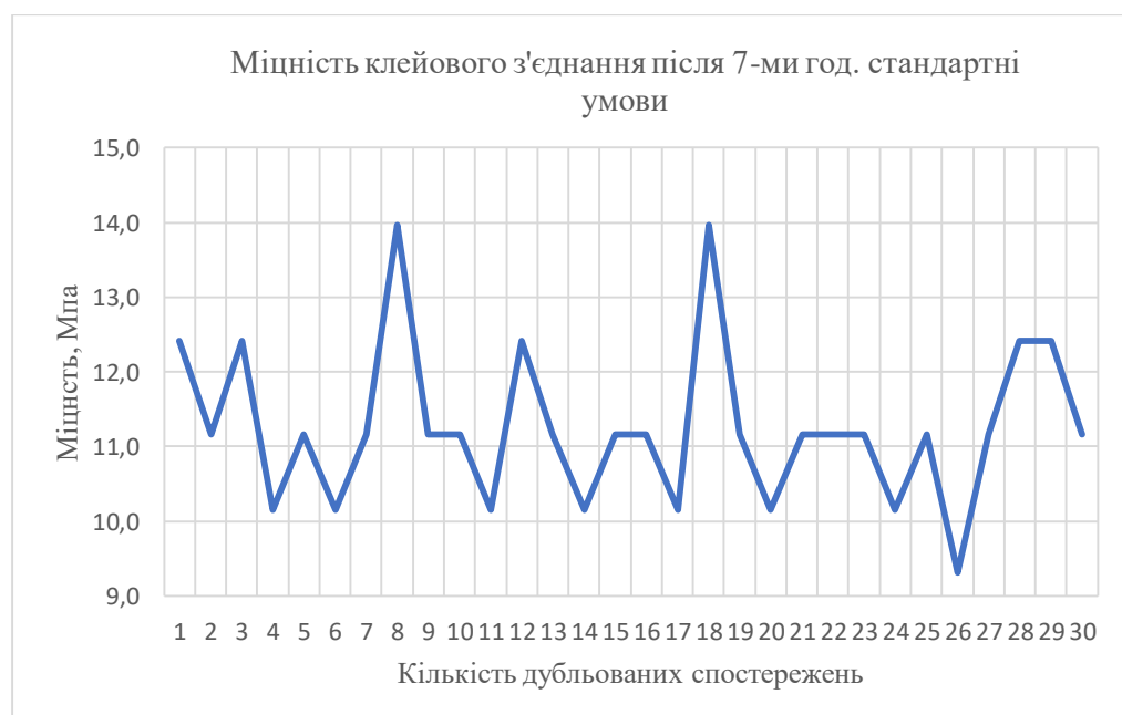
Рис. 4.4. Зміна міцності клейових з'єднань деревини ясена після 7 годин витримки у стандартних умовах.
