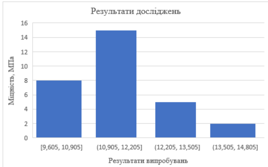
Рис. 4.8. Гістограма міцності клейових з'єднань деревини ясена після циклічних температуро-вологісних випробувань
