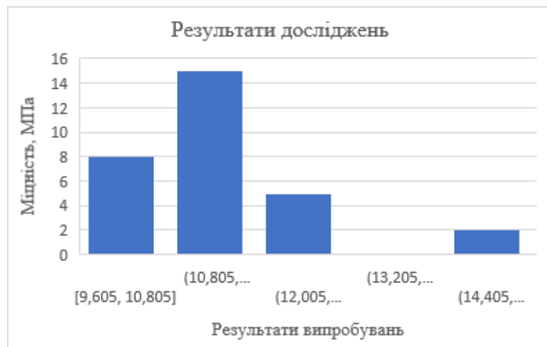
Рис. 4.9. Гістограма циклічних температурно-вологісних випробувань.
