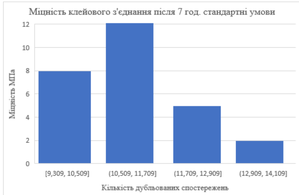
Рис. 4.3. Гістограма міцності клейового з'єднання після 7 годин витримки у стандартних умовах
