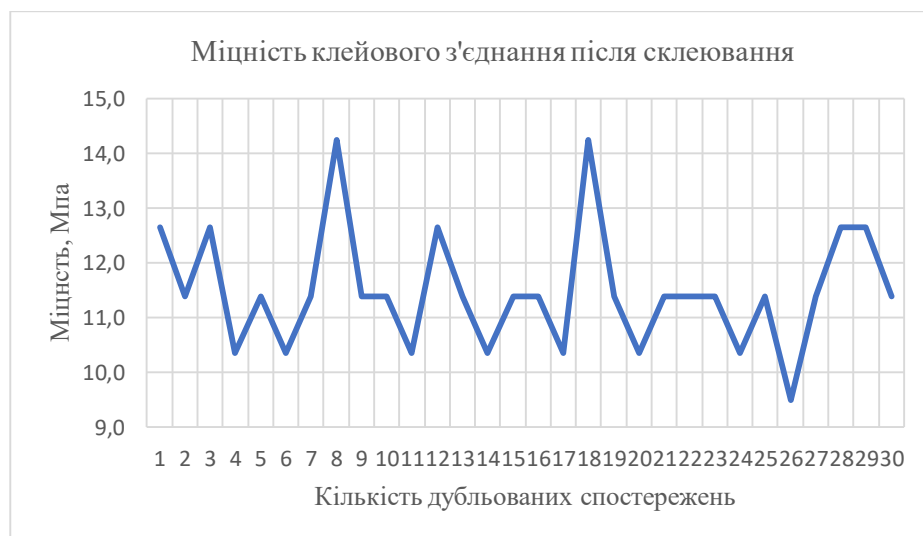
Рис. 4.2. Зміна міцності клейових з'єднань деревини ясена.
