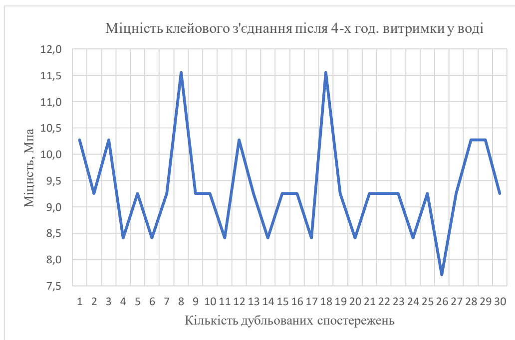
Рис. 4.6. Зміна міцності клейових з'єднань деревини ясена після 4 год. у воді
