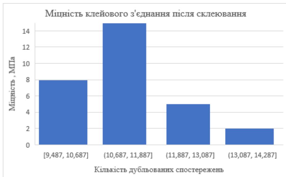
Рис. 4.1. Гістограма міцності клейових з'єднань деревини ясена.
