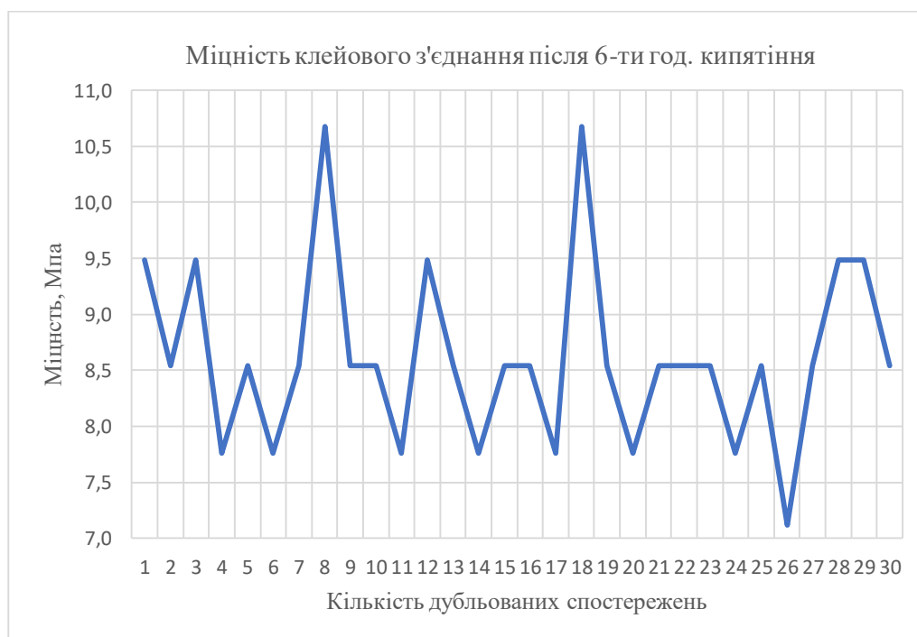
Рис. 4.8. Зміна міцності клейових з'єднань деревини ясена після 6 год. кип'ятіння.
