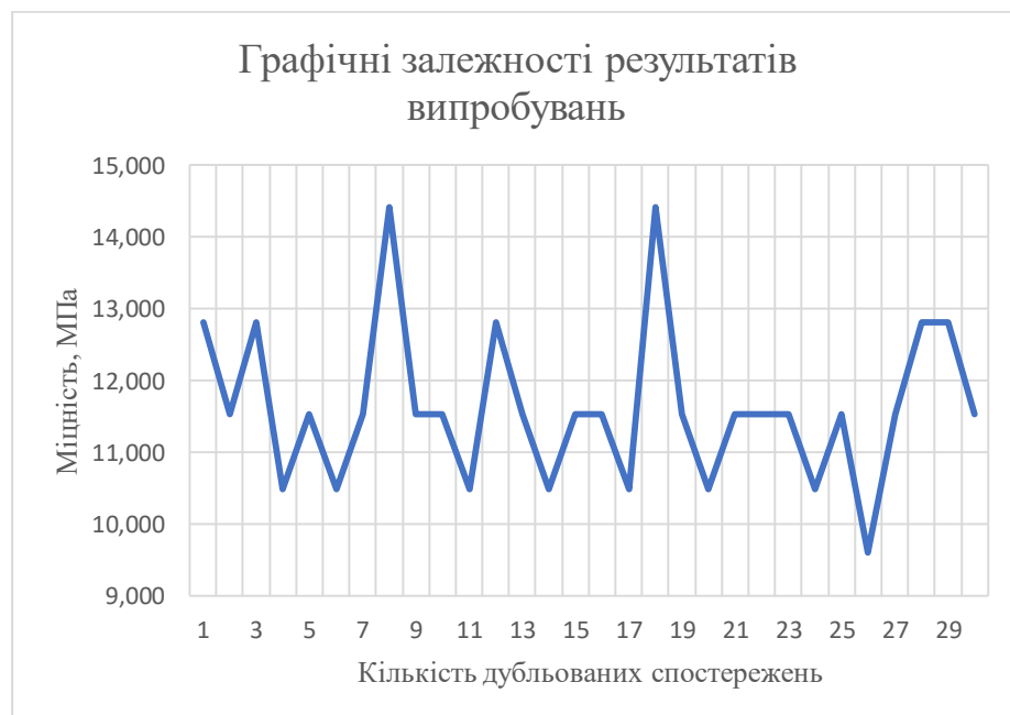
Рис. 4.8. Зміна міцності клейових з'єднань деревини ясена після циклічних температуро-вологісних випробувань
