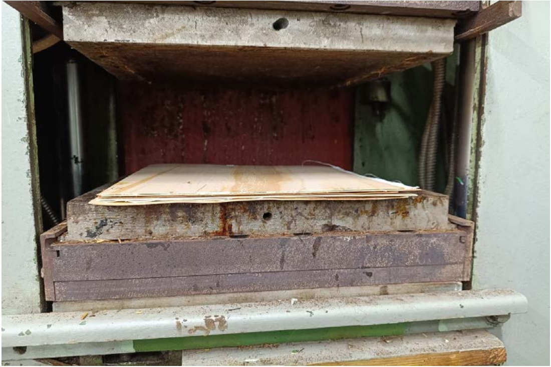
Рис 2.5. Розміщення пакета в пресі
