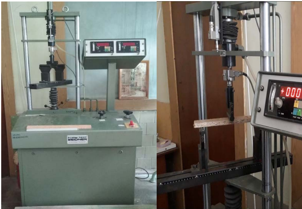
Рис. 2.13. Визначення межі міцності при статичному згині та модуля пружності: 1 – машина для випробування ВР 5 5HV; 2 – процес дослідження зразка
