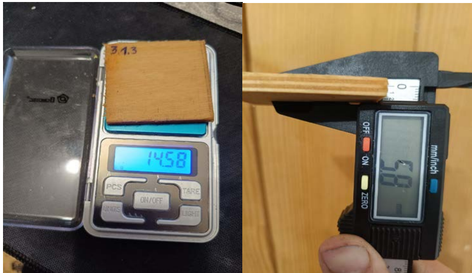
Рис. 2.9. Приладдя для визначення водопоглинання зразків фанери: 1 – електронна вага; 2 – штангенциркуль
