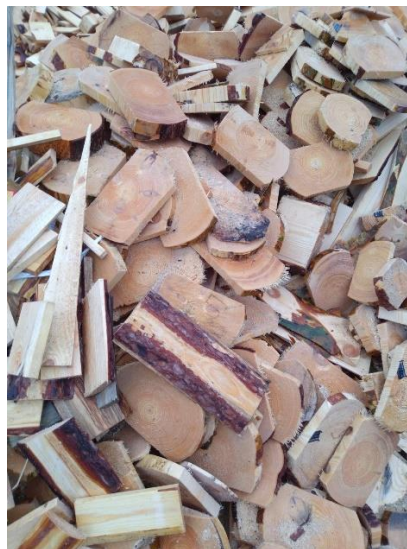
Рис. 3.4. Відходи після торцювання.
