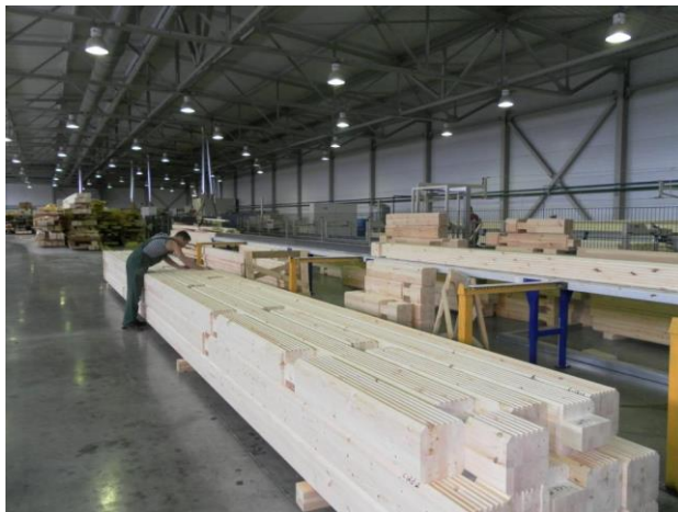
Рис. 2.2. Технологічний процес виготовлення клеєного бруса із деревини порода сосна.
