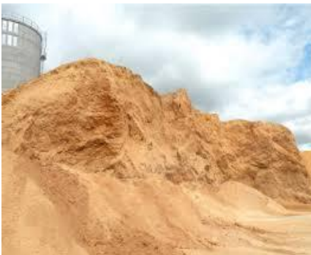
Рис. 1.5. Відходи при розкроюванні колод на пиломатеріали.
