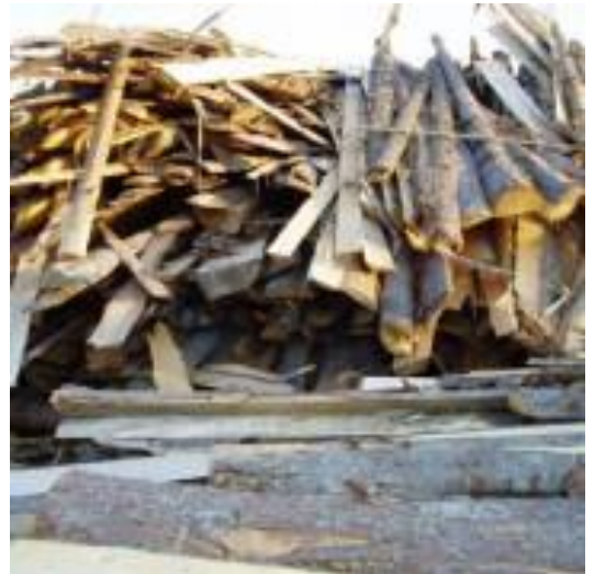
Рис. 1.5. Відходи при розкроюванні колод на пиломатеріали.
