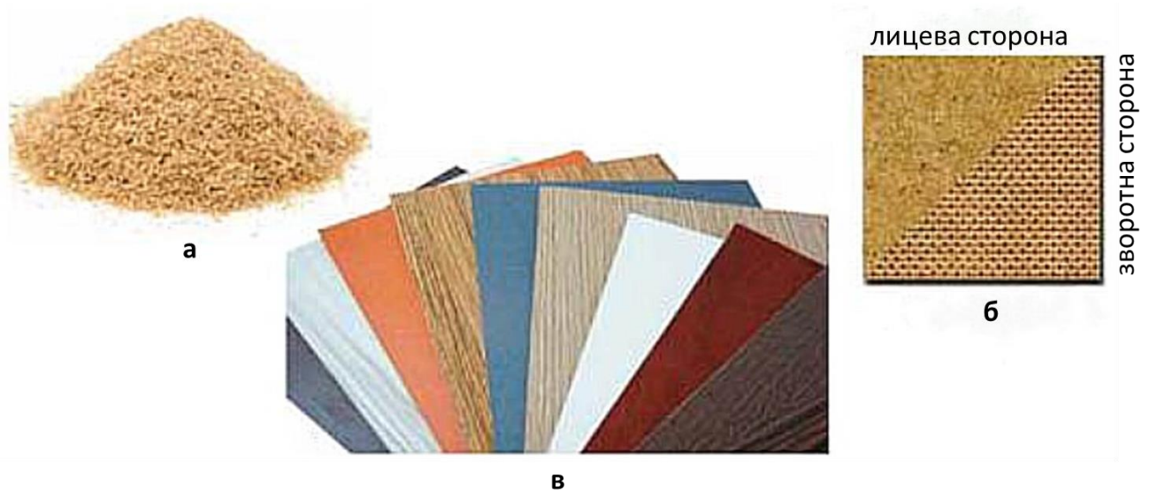
Рис. 1.8. Зразок ВП: а – сировина для ВП; б – лицева та зворотна сторони ВП; в – ламіновані ВП
