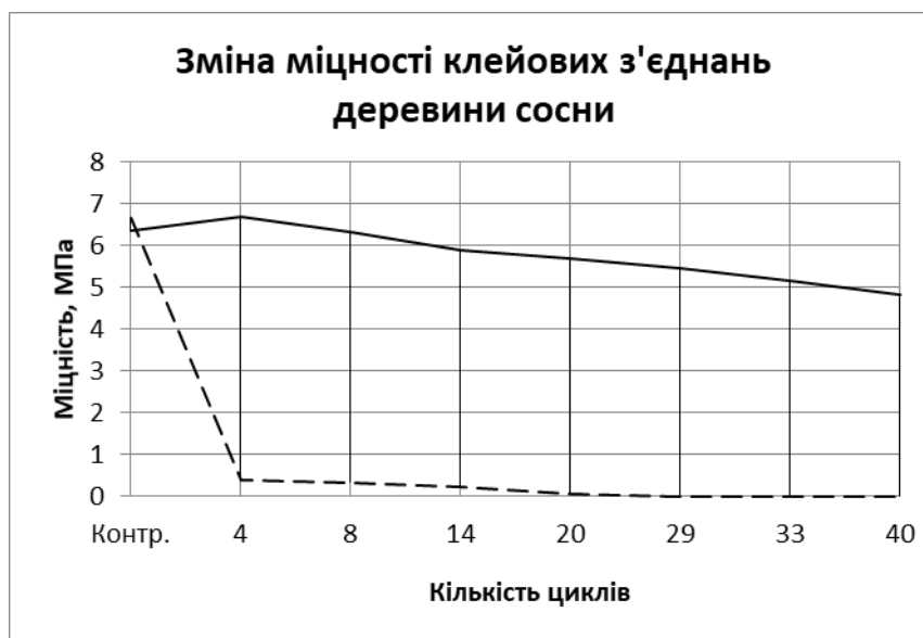
Рис. 4.2. Міцність клейових з'єднань деревини сосни після циклічних температурно вологісних випробувань у лабораторних умовах.
