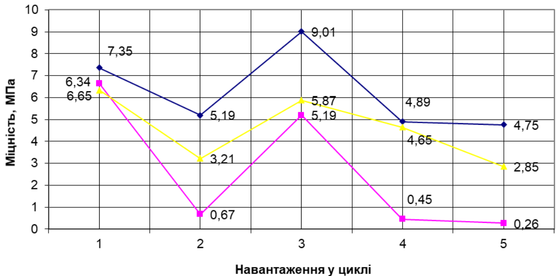
Рис. 4.3. Зміна міцності клейових з'єднань деревини сосни клеями із ступенем довговічності D4 залежно від циклічної дії вологості та температури.
