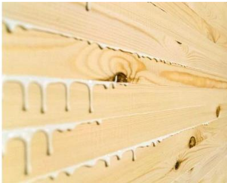
Рис. 5.2 Склеювання деревини полівінілацетатними клеями.
