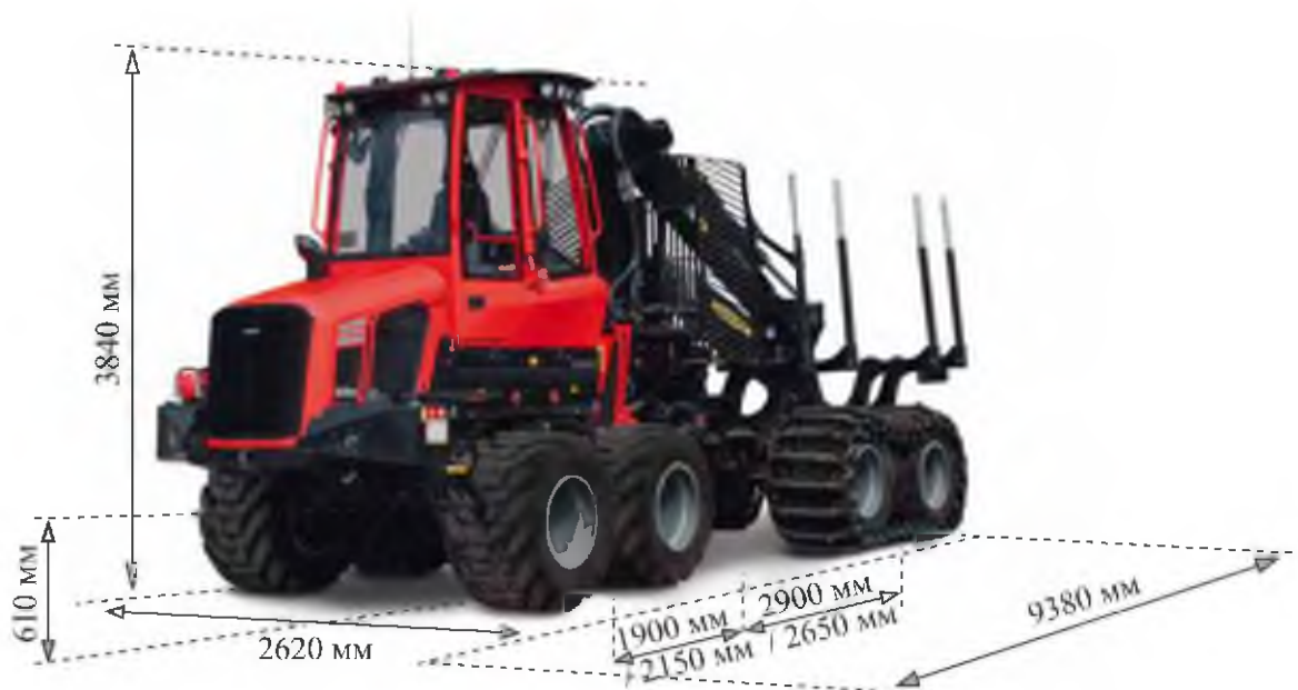
Рисунок 3.2 – Трелювальна машина Komatsu 835TX – компонування та розмірні характеристики
