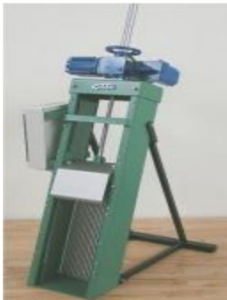
Рис. 3.4. Решітка для механічного очищення стоків
