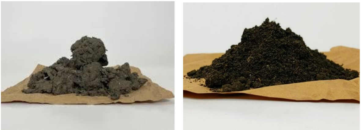
Рис. 4.2. Скоп із стічних вод від целюлозно-паперового виробництва
