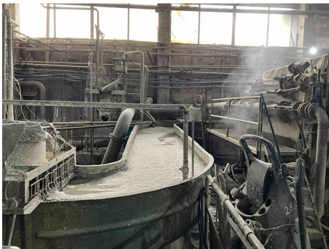
Рис. 1.2. подача целюлозної маси на формування паперового полотна
