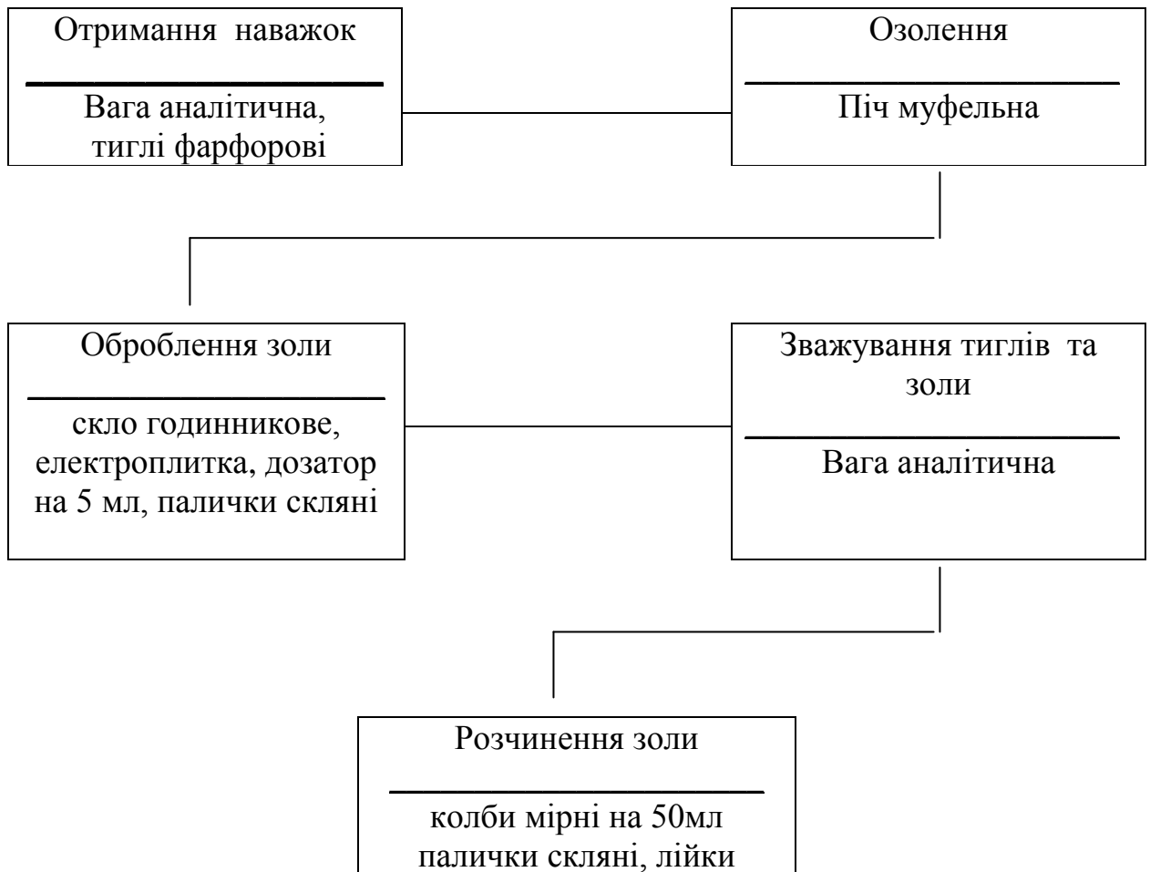
Рис. 4.1. Технологічна карта проведення озолення зразків
