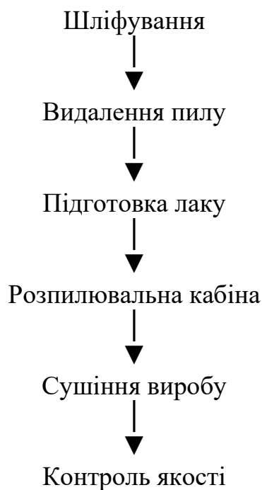
Рисунок 5.2 Схема безпечного виконання опоряджувальних робіт
