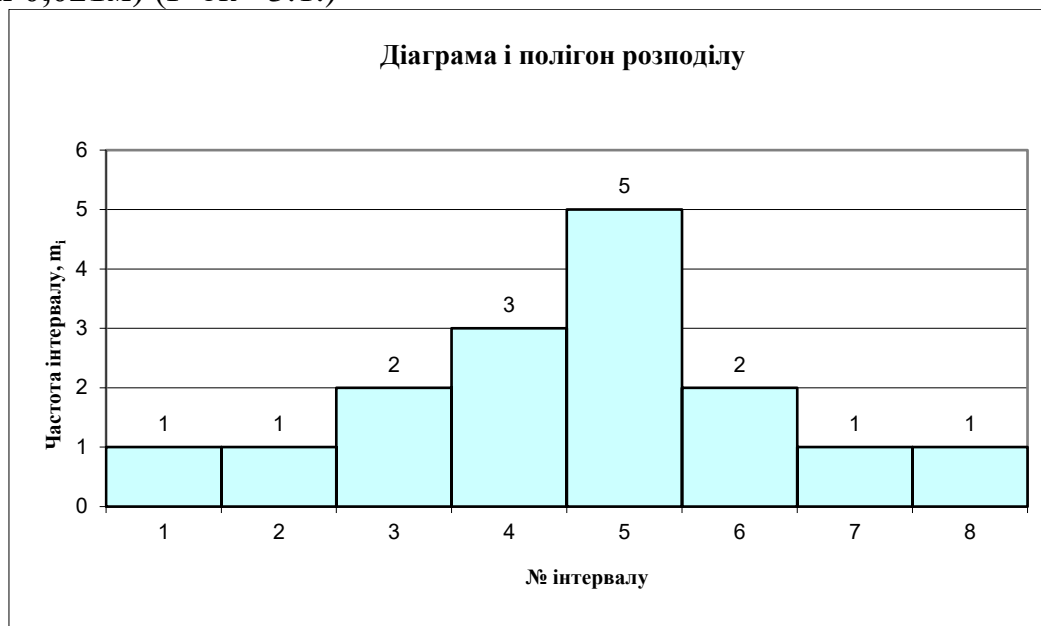
Рис. 3.1. Гістограма з частотою розподілу кількісних даних величини межі міцності на згин статичний для клеєних меблевих щитів (порода бук) за товщини ширина крайки 0,021м при застосування рейок шириною 0,060м здійснено для порівняльних випробувань типом на фугу гладку (ширина крайки 0,021м)
