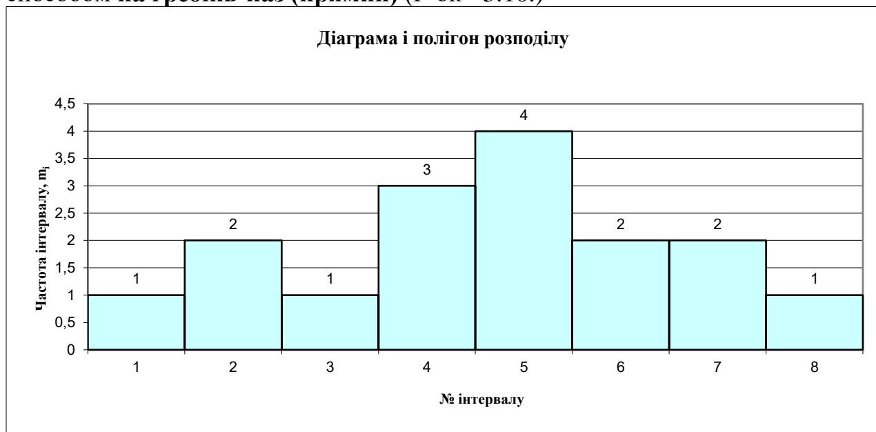
Рис. 3.10. Гістограма з частотою розподілу кількісних даних величини межі міцності на сколювання для клеєних меблевих щитів (порода бук) за товщини ширина крайки 0,021м при застосування рейок шириною 0,060м здійснено для порівняльних випробувань типом на гребінь-паз (прямий)
