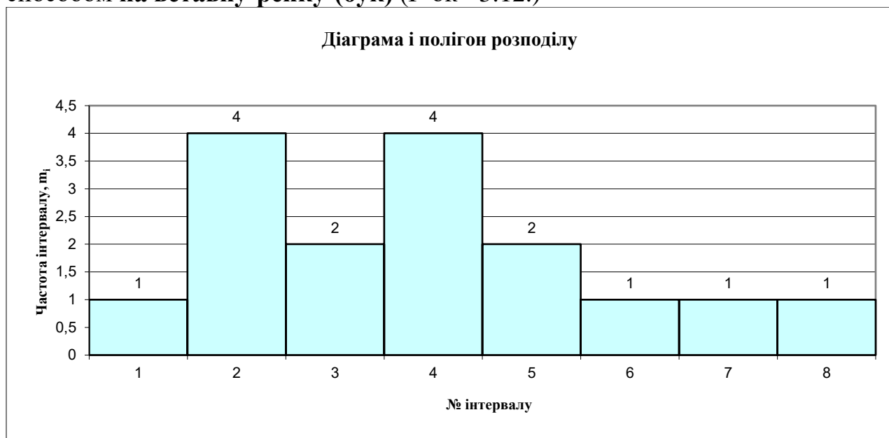
Рис. 3.12. Гістограма з частотою розподілу кількісних даних величини межі міцності на сколювання для клеєних меблевих щитів (порода бук) за товщини ширина крайки 0,021м при застосування рейок шириною 0,060м здійснено для порівняльних випробувань типом на вставну-рейку-(бук)
