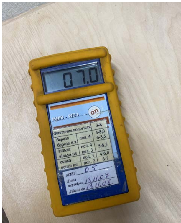
Рис. 2.3 – Визначення вологості луценого шпону вологоміром HMB-WS1
