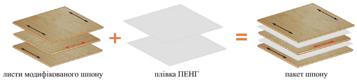
Рис. 2.6 – Схема формування пакета шпону
