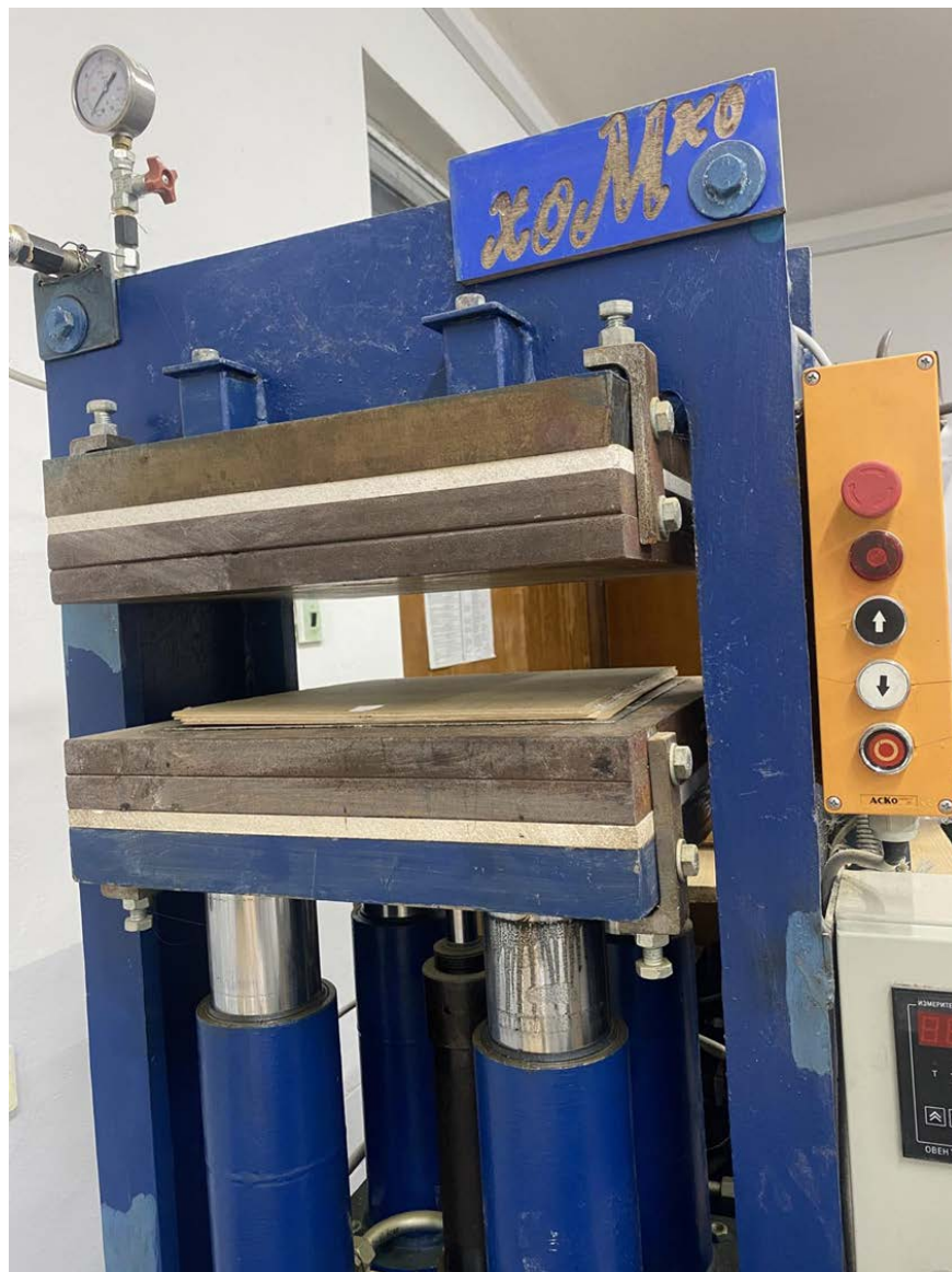
Рис. 2.7 – Склеєний лист фанери в лабораторному пресі “Хомко”
