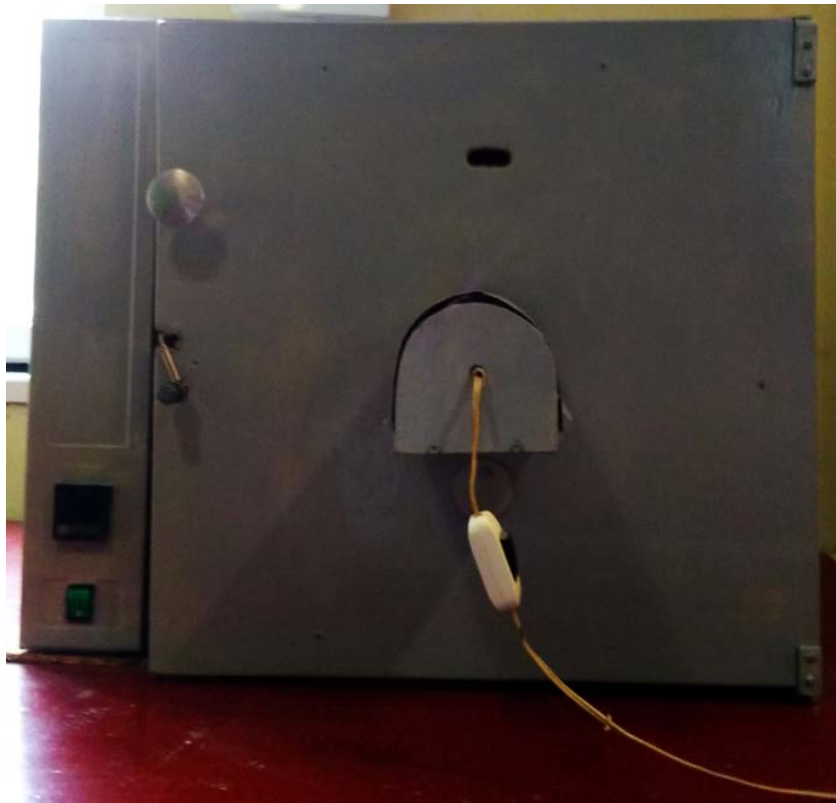
Рис. 2.2 – Сушіння шпону у сушильній шафі SNOL 67/350
