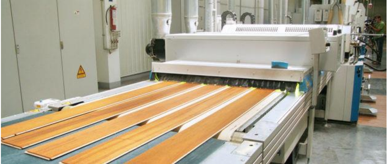
Рис. 2.2. Лінія для виготовлення паркетної дошки.
