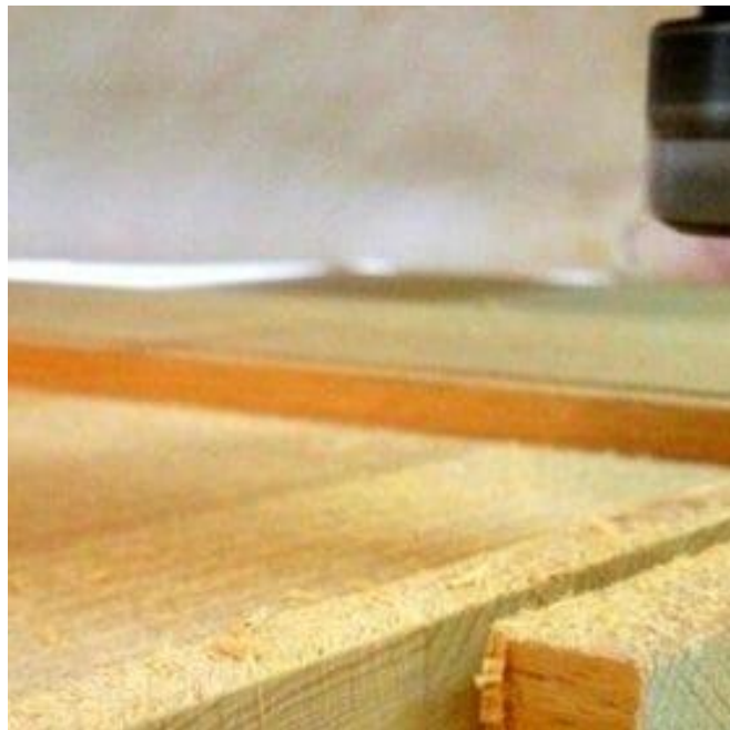
Рис. 3.6. Утворення стружки та деревинного пилу після фрезерування
