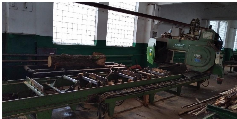
Рис. 2.4. Розпилювання колод на пиломатеріали
