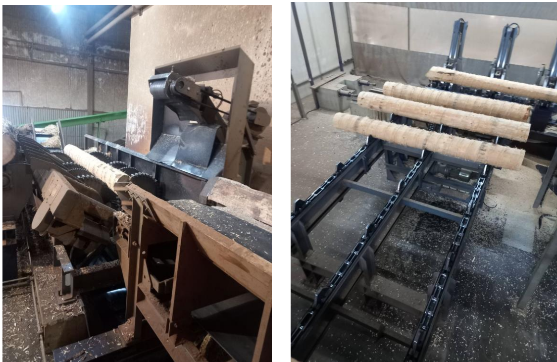
Рис. 2.3. Технологічний процес корування деревини
