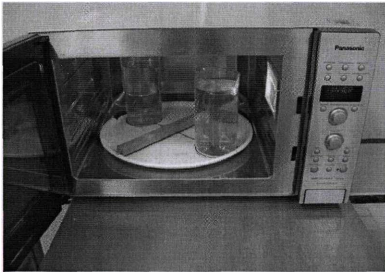
Рисунок 2.1. Розміщення зразка та склянок з водою в мікрохвильовій печі
