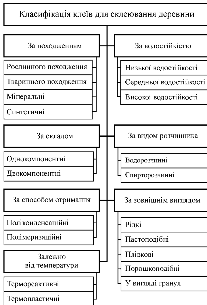
Рис. 1.3. Класифікація клейових матеріалів для склеювання деревини
