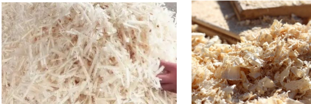
Рис. 3.1 Розміри та форми стружки при механічній обробці деревини на фугувальних та рейсмусних верстатах.
