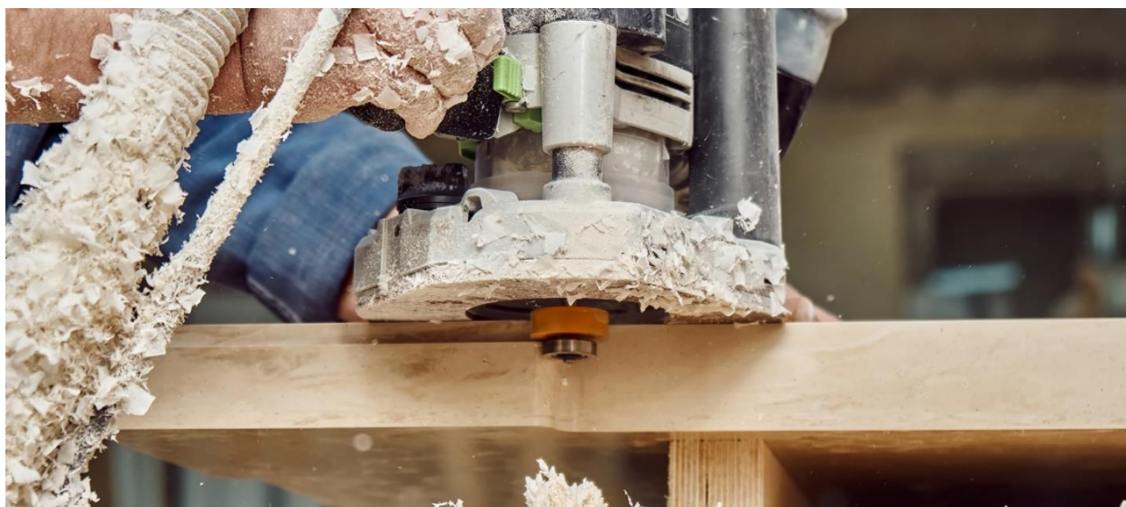
Рис. 4.5 Інноваційна установка для вловлювання пилу від обладнання вторинної механічної обробки.
