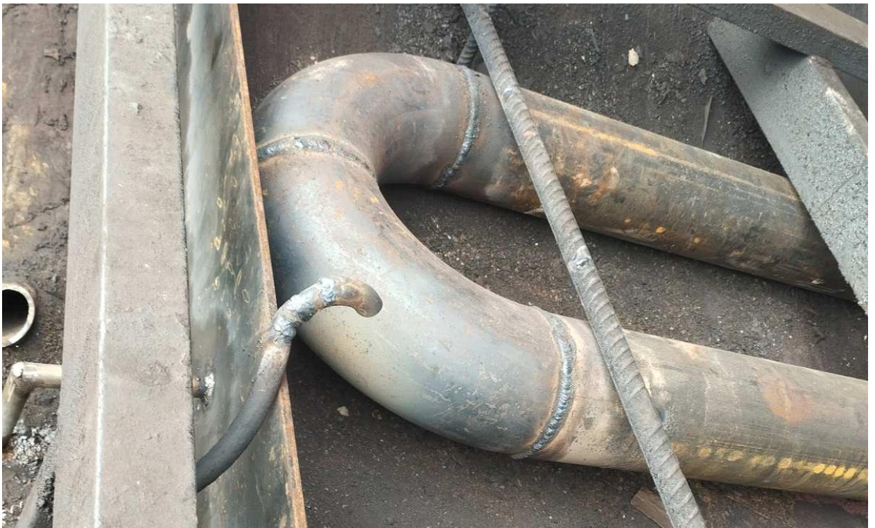
Рисунок 1.9. Загальний вигляд димової труби в нижній частині термокамери для нагрівання топковими газами і нагрівання води в басейні.
