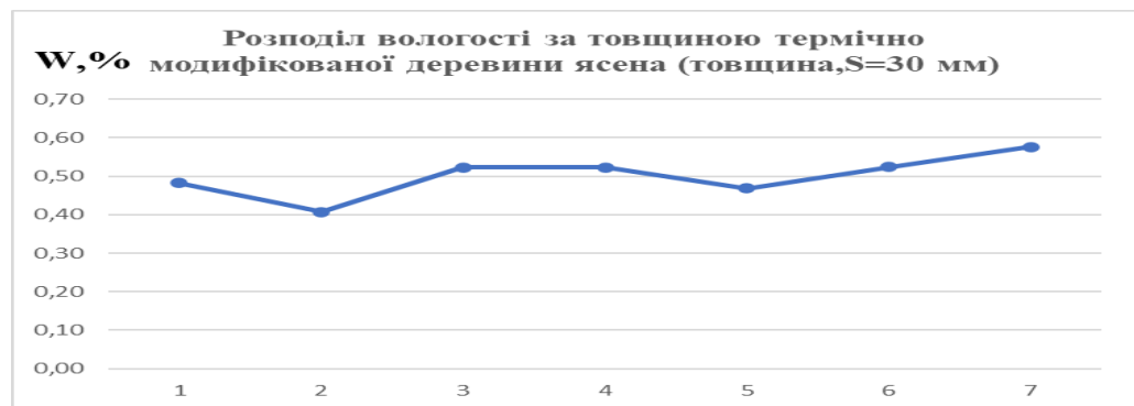
Рисунок 1.12. Приклад розподілу величин кінцевої вологості термомодифікованих пиломатеріалів з деревини ясеня товщиною 30 міліметрів сухим способом.
