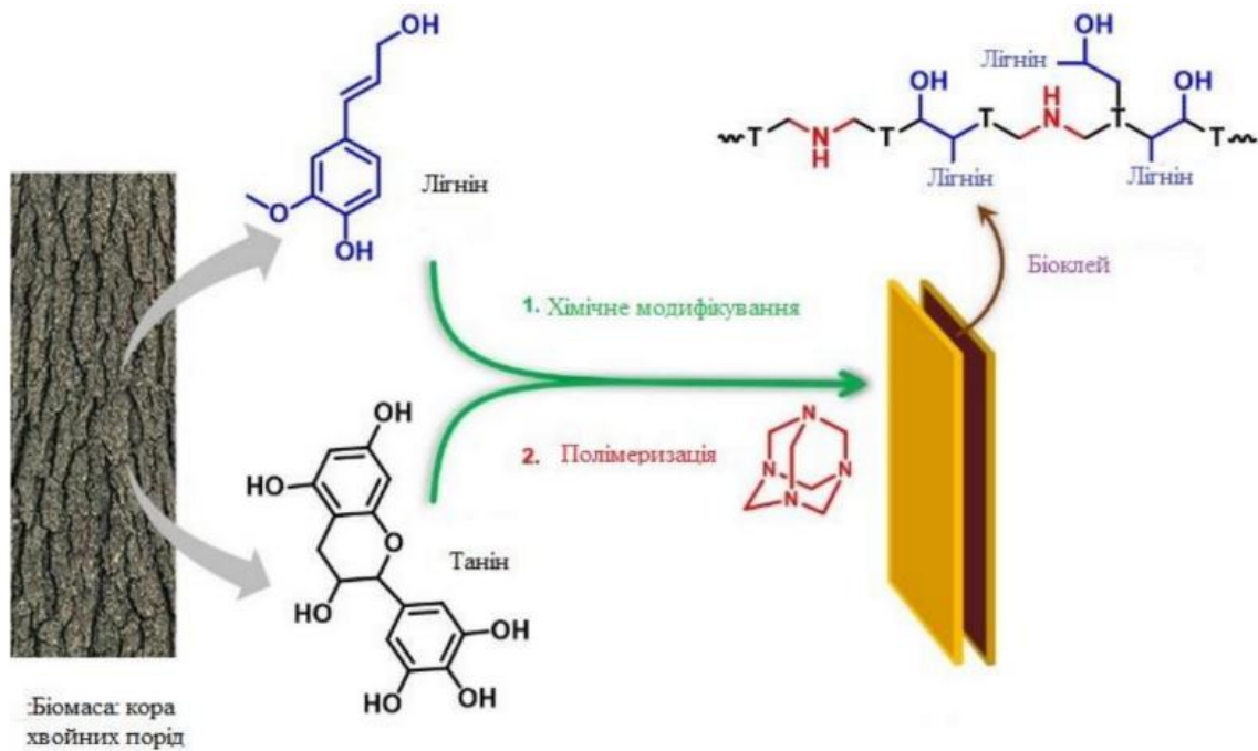
Рисунок 1.5. Процес утворення клею на основі таніну з лігніном
