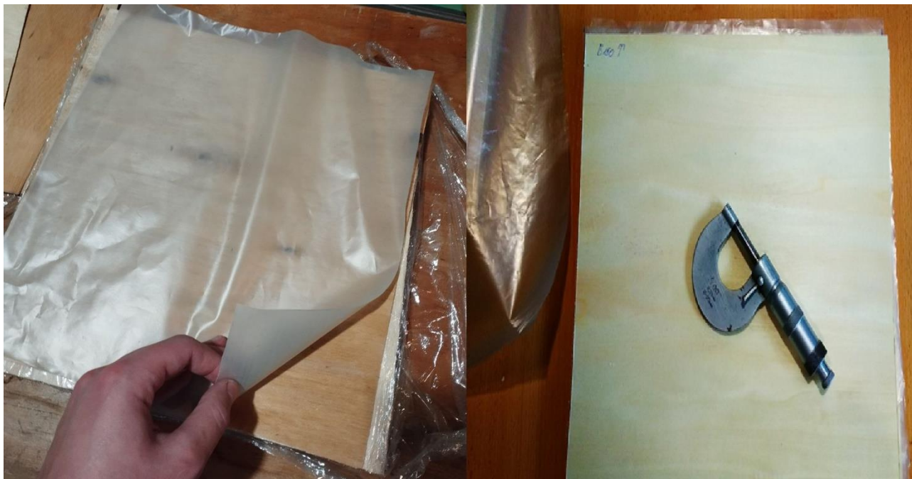
Рис. 2.1. Визначення товщини термопластичної плівки мікрометром МК-25 0,01
