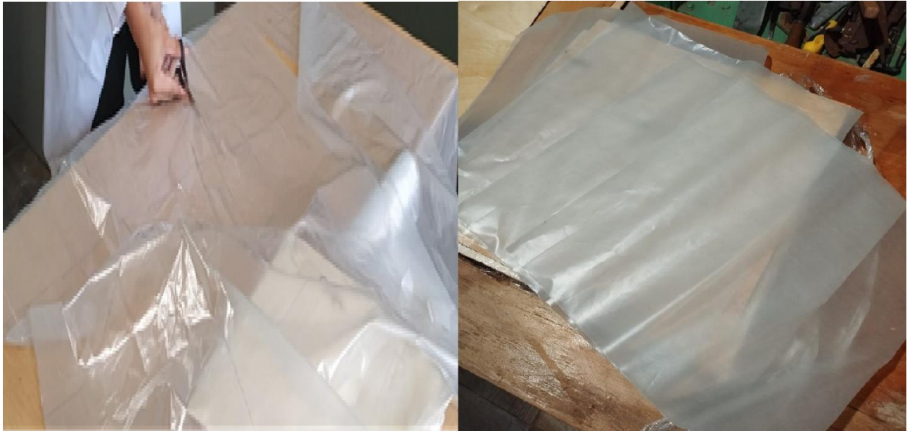
Рис. 2.5. Робочий момент розкроювання плівки ПЕНГ(в)
