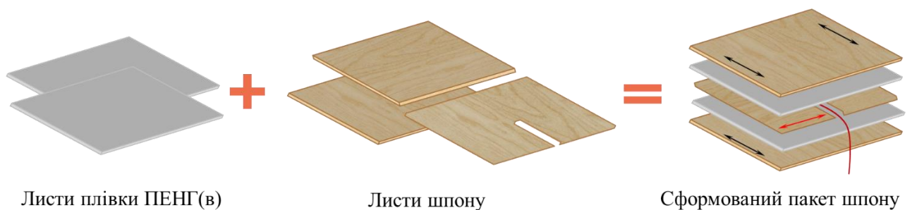
Рис. 2.6. Схема формування пакету шпону
