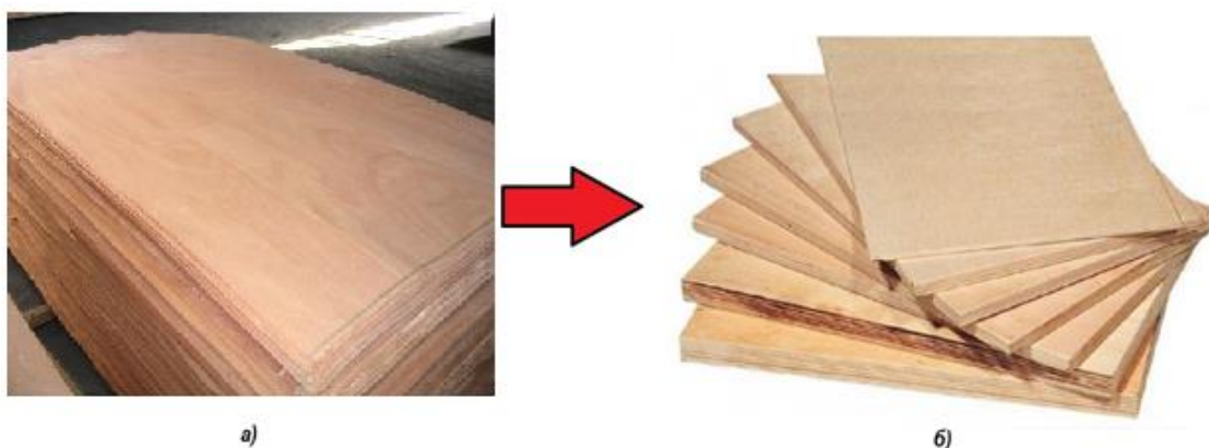
Рис. 1.6. Зразки матеріалів : а) листи луценого шпону; б) листи фанери
