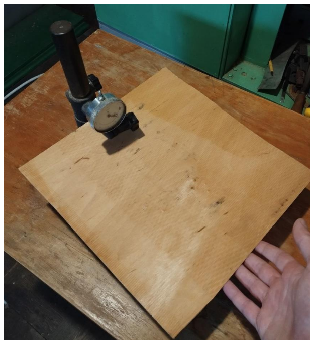
Рис. 2.3. Робочий момент визначення товщини шпону
