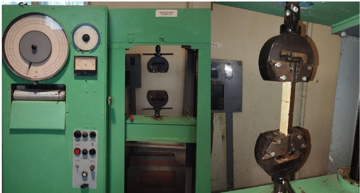
Рис. 2.11. Момент визначення міцності фанери на зріз на випробувальній машині PM-05
