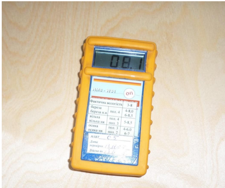
Рис. 2.4. Робочий момент визначення вологості лущеного шпону
