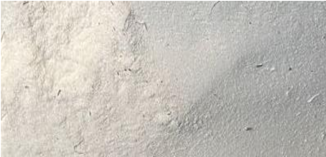
Рисунок 2.1. Загальний вигляд фракційності тирси після вертикального стрічковопилкового верстата PREMULTINI.
