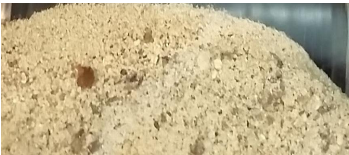
Рисунок 2.2. Загальний вигляд фракційності тирси після круглопилкових верстатів.
