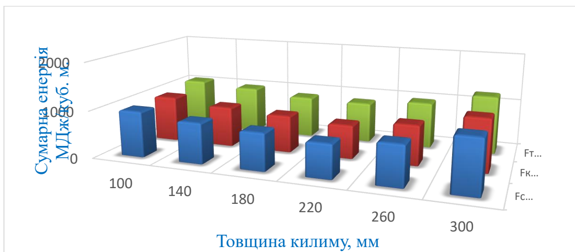
Рисунок 2.13. Діаграми зміни сумарних питомих витрат енергії (електричної і теплової) в стрічковій сушарці в залежності від фракційності і товщини шару висушуваного матеріалу.
