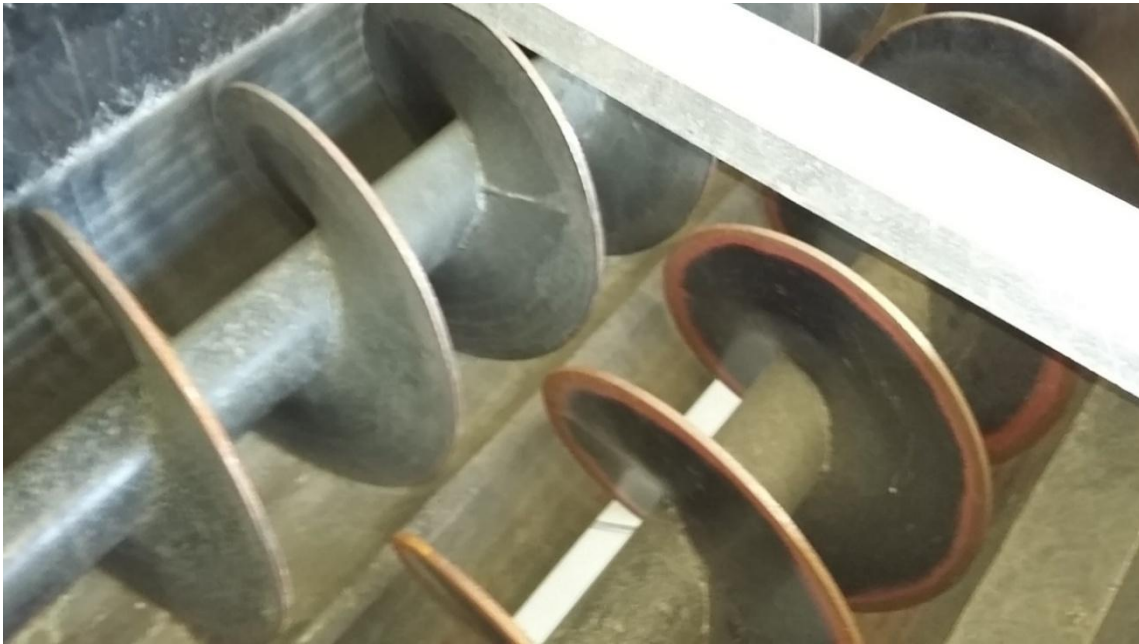
Рисунок 2.8. Загальний вигляд двошнекового розподільчого пристрою супорта завантаження стрічкової сушарки.
