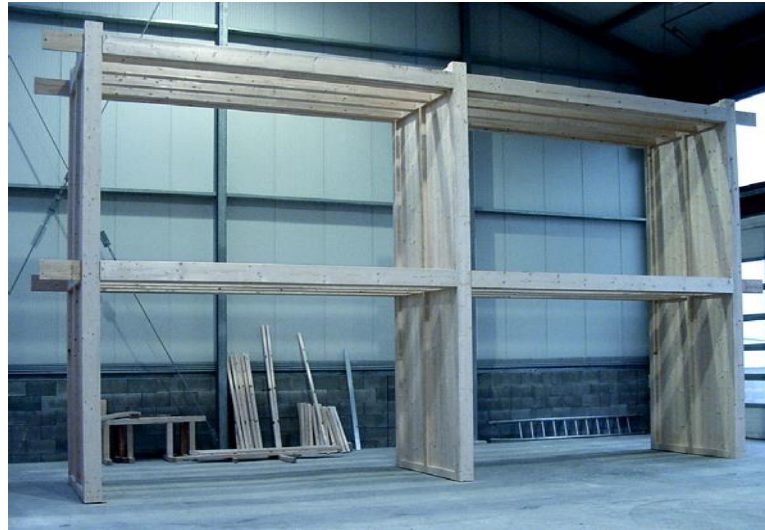
Рис. 50. Напівжорсткий каркас для багатоповерхових дерев'яних будівель.
