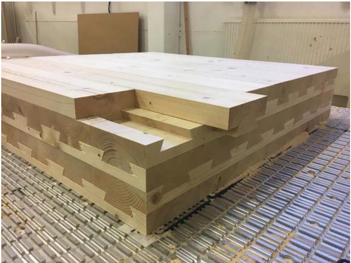
Рис. 13. Тестовий зразок елемента з дерев'яної дошки типу «ластівчин хвіст» без клею та металевих кріплень.
