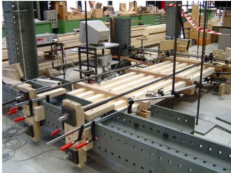
Рис. 48. Випробування запропонованої стіни на зсув на EPFL-IBOIS
