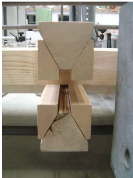
Рис. 49. Деталь стику «в шаховому порядку колони – обхвати».
