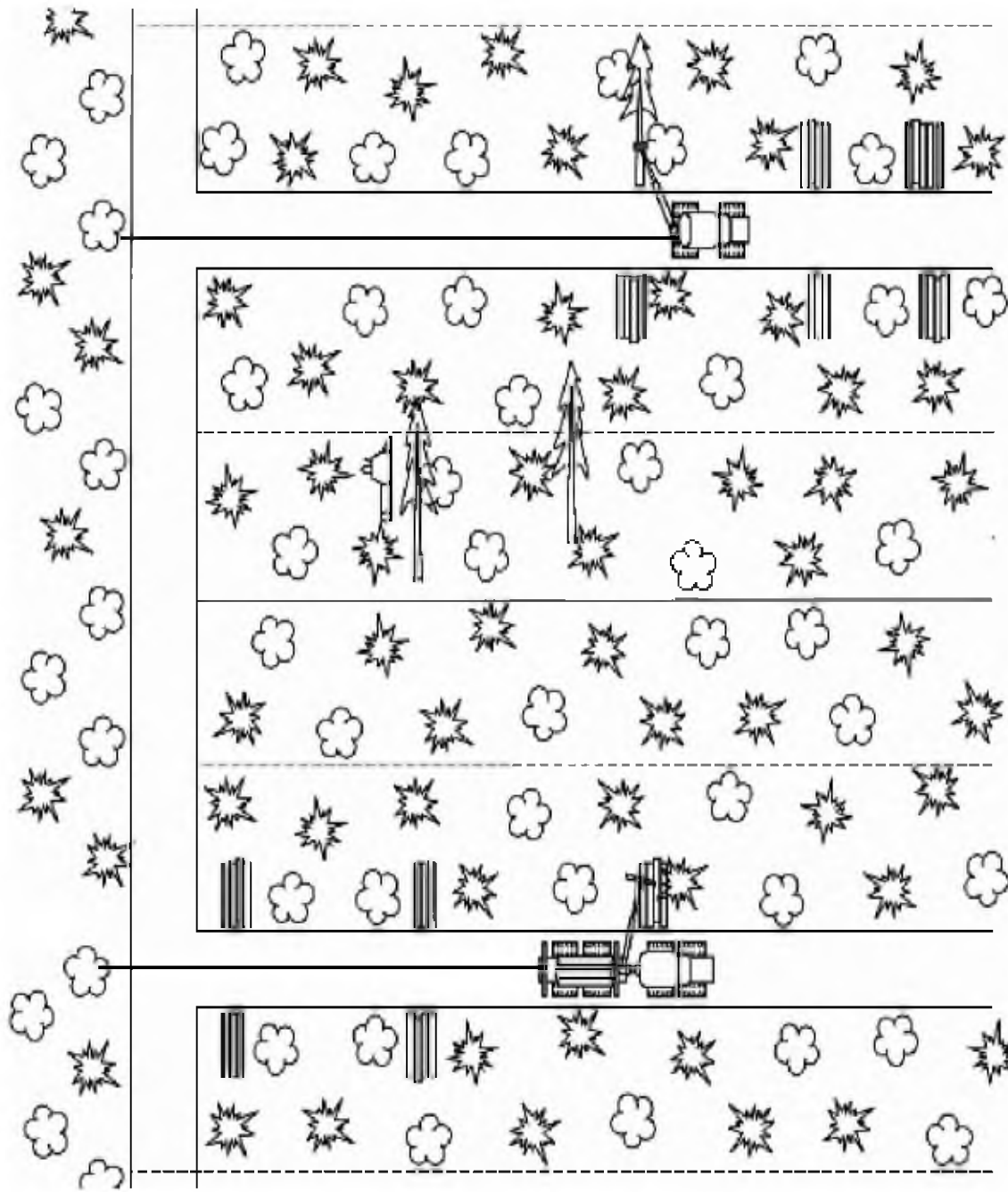
Рисунок В.2 – Вибіркові рубки – на базі лісосічних машин обладнаних тяговими лебідками
