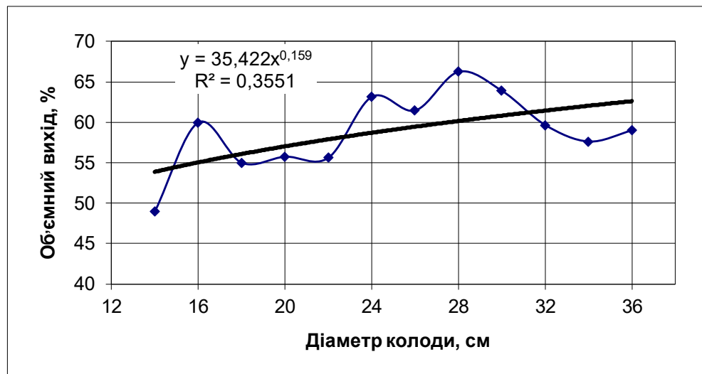
Рис.3.3. Об'ємний вихід пиломатеріалів та заготовок піддонів із дров'яної сировини
