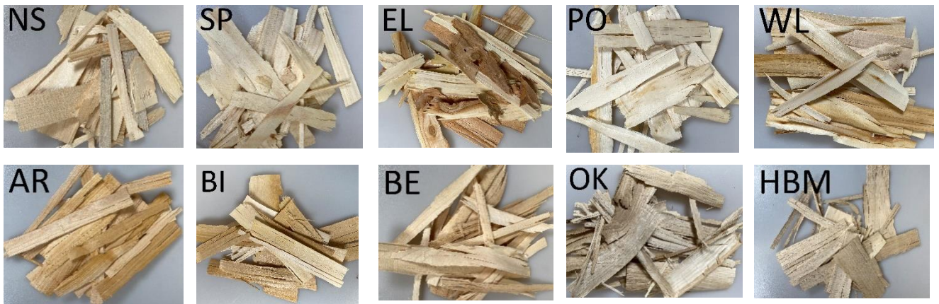
Рисунок 1 Стружка, що використовується для виготовлення OSB
